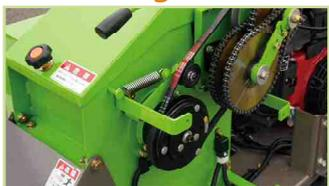
Sistema di alimentazione automatica a frizione elettromagnetica col dispositivo No Stress. Triturazione facile e prestazioni superiori.
