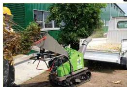
Conveniente e adeguato a scaricare il cippato su un camion leggero. Espulsione ad una altezza da 70 a 100 cm.
