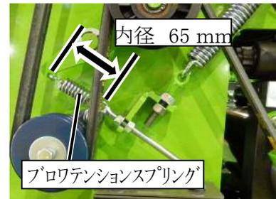
6. パワーパックベルトを取り付け、Pテンションアームスプリングの長さが写真のようになるまで張って下さい。
