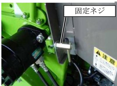
4. 受刃を下側から固定しているM12の受刃固定ボルト（3本）を外して下さい。
