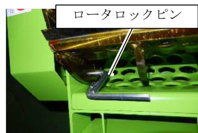
5. 六角レンチにて六角穴付皿ボルト(4本)を固定し、裏側にあるナットを緩め六角穴付皿ボルト(4本)を外して下さい。
