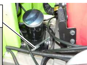
ロータロックピン収納位置
