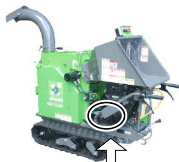
ロータロックピン収納位置
