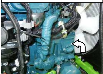
エンジンオイル (カバー内)
