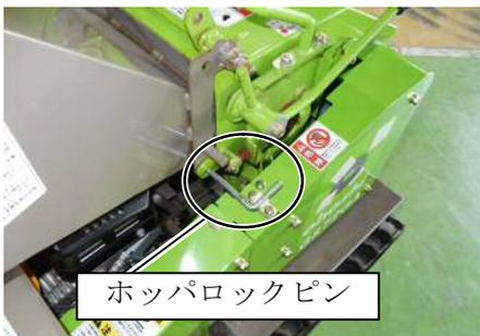
10. 抜いたホップロックピンを挿して、ホップを固定して下さい。
