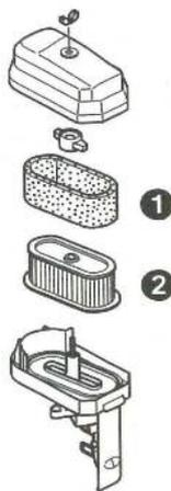
(2) エレメントを取り付けてカバーを取り付けて下さい。
