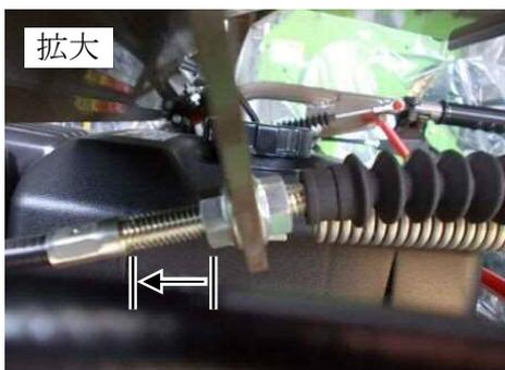
3. 走行クラッチレバーを「下」位置（走行クラッチが切れます）にしてエンジン始動の要領でエンジンを始動し、走行ベルトクラッチが確実に切れることを確認して下さい。
