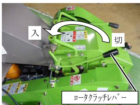
3. 定速になったら、ロータクラッチレバーを「入」位置に向けてゆっくり倒します。
