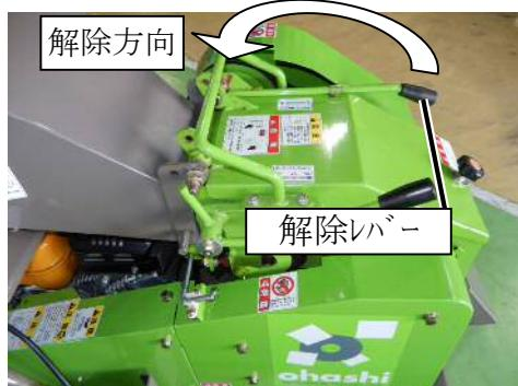
送りローラに材料が噛み込む、枝等が引っかかるなどの材料が入っていないときは、解除レバーを解除方向に引いて下さい。材料を一度引き出し投入する向きを変えて再度投入して下さい。
