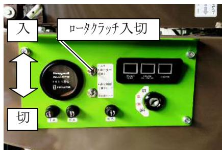
1. ロータクラッチが、確実に切れている事を確認してからエンジンを始動させ、スロットルレバーを「低」位置にします。
