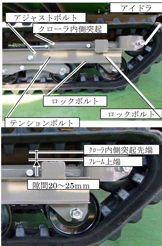
3. 調整後は、ロックボルトとアジャストナットを確実に締め付けてアイドラーを固定して下さい。
