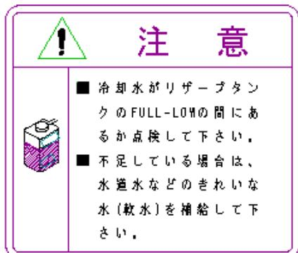
冷却水がリザーブタンクのFULL-LOWの間にあるか点検して下さい。
