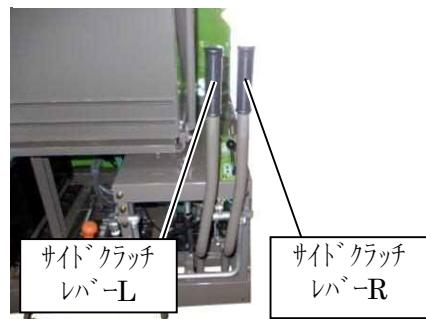
1. 左折する場合は、左側のサイドクラッチレバーを手前に引きます。左側のクローラが停止し、機体は左折します。
