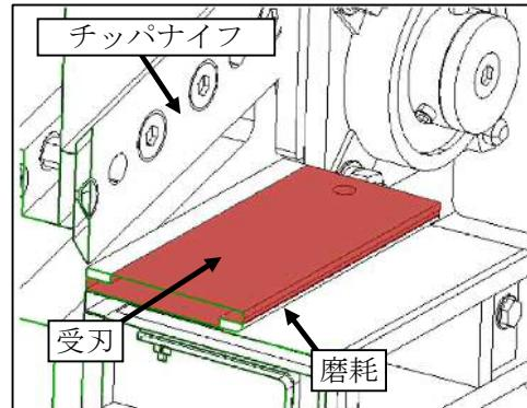
4. 受刃の調整(P29)の要領で受刃の調整を行い、受刃固定ボルト（2本）をしっかりと締め付けます。
