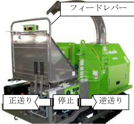
1. フィードレバーを手前に引くと送りローラは正転し材料をロータ内部へ搬送します。
