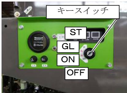
6. エンジン始動後、負荷をかけずに5分間、低速で暖気運転します。（エンジン取扱説明書参照）
