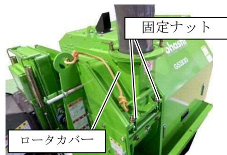
2. ロータクラッチスイッチを「切」位置にして、ロータを回しチッパナイフが点検窓にくる位置にします。
