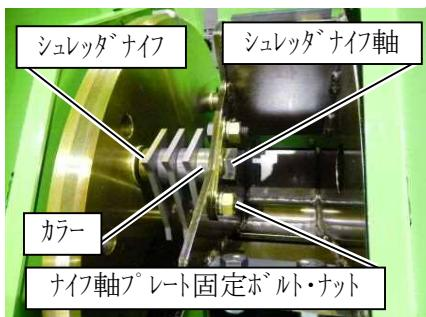
5. シュレッダナイフ軸をネジ込んでSプレートにナイフ軸プレートを接触させ穴（2ヶ）を合わせ、固定ボルト・ナットを差し、しっかりと締め付けます。
