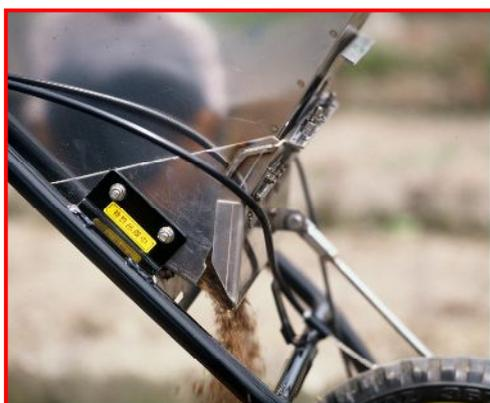
特許出願の機構により化学肥料から落ちにくい有機肥料まで、つまることなく安定的に排出します。また、肥料が直接接触する部分は全てステンレスを採用しており、サビにくく、水洗いができ、手入れも簡単です。
