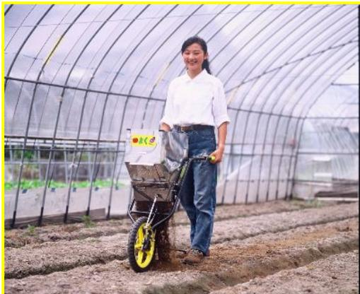
散布調整ガイド板を取り外せば、直下のスジまきが行えます。
