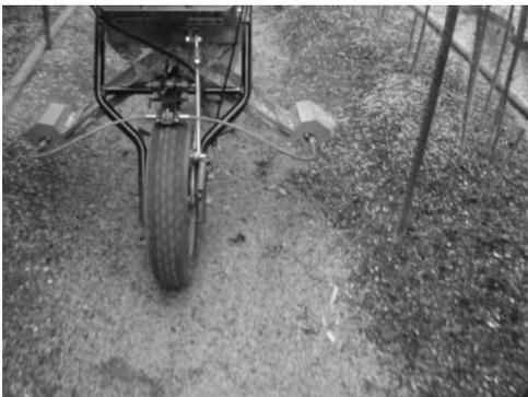
散布調整ガイド板は、伸縮と傾斜角が調整式で、作物の成長に応じてねらったポイントへ散布できます。
