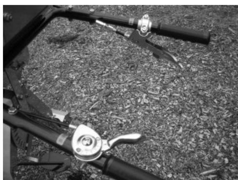
目盛付散布調整レバーを左ハンドルに設け、散布作業中(走行中)でも、作業を中断することなく、手元で簡単に微調整できます。
