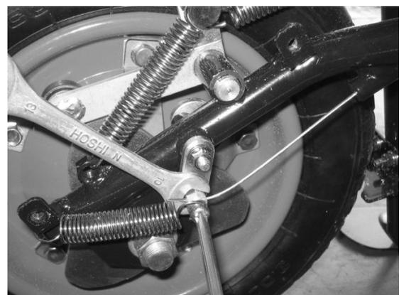
3. フラップシャッターの全閉時の隙間調整(作業中)
