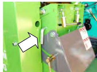
3. チップナイフを固定しているM12のネジ(ナット側4ヶ)を緩めて入れ換えます。
