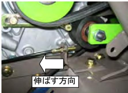
4. 走行クラッチレバーを「下」位置（走行クラッチが切れます）にしてエンジン始動の要領でエンジンを始動し、走行ベルトクラッチが確実に切れることを確認して下さい。
