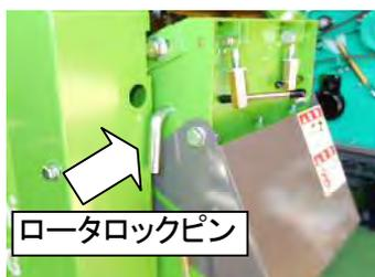
4. 六角レンチにて六角穴付皿ボルト (4本) を固定し、裏側にあるナットを緩め六角穴付皿ボルト (4本) を外して下さい。
