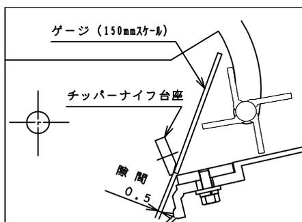
5. 手でロータをゆっくり回して、2枚のチップナイフと受刃が当たらないこと、隙間が0.5mm前後あることを確認して下さい。
