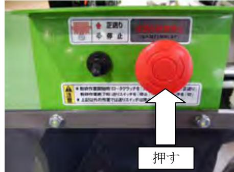
2. 正送り非常停止スイッチは、右へ回すと解除します。（スイッチが元の位置に飛び出します。）
