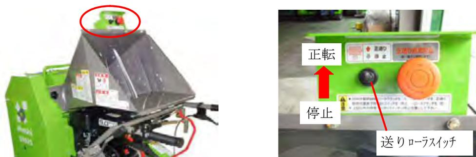
⑧ 作業が終わりましたら、⑦送りローラスイッチ「停止」→⑤スロットルレバー「低」→⑥ロータークラッチレバー「切」の順で、始めの位置に戻し終了してください。
