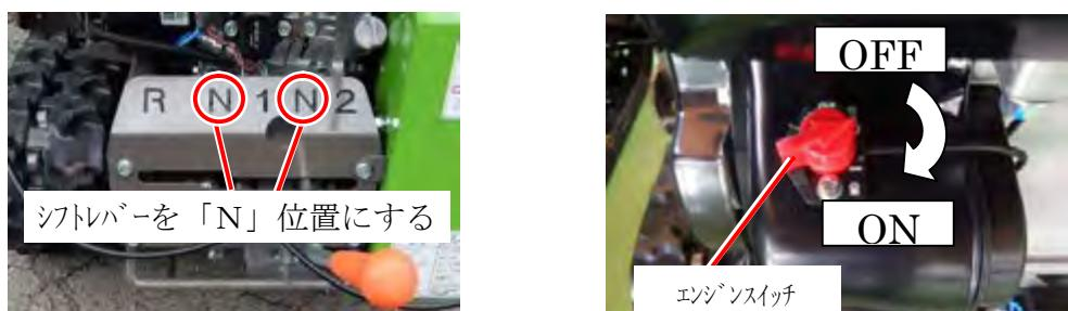
④ 燃料コックを「開」、チョークを「閉」方向にし、スタータグリップを握り圧縮位置まで軽く引き、勢いよく最後まで引きあげ、エンジンをかけます。エンジンが始動したらチョークを「開」の位置にもどします。
