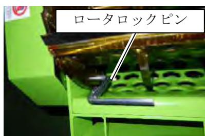
4. 六角レンチにて六角穴付皿ボルト（4本）を固定し、裏側にあるナットを緩め六角穴付皿ボルト（4本）を外して下さい。
