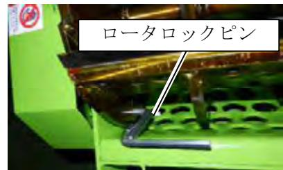
3. チッパナイフを固定しているM12のネジ（ナット側4ヶ）を緩めて入れ替えます。
