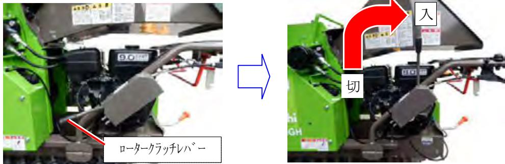
⑦ 投入口上部の送りスイッチを正送りへすると、粉碎作業が出来ます。
