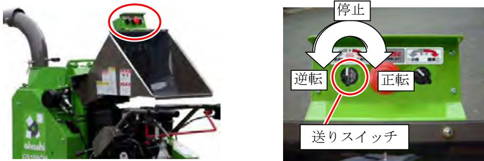
⑧ 作業が終わりましたら、⑦送りスイッチ「停止」→⑤スロットルレバー「低」→⑥ロータクラッチレバー「切」の順で、始めの位置に戻し終了してください。
