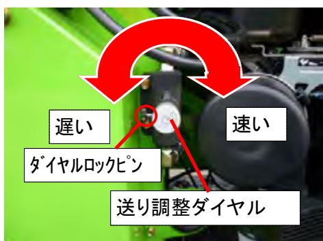
※5mm ・ 8mm スクリーンをつけた場合のダイヤル調整方法は、送り調整ダイヤルを左方向(遅く)へ全部回し、投入口に直径7cm前後の竹や木を投入し、下記の要領で行ってください。
