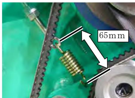
6. パワーパックベルトを取り付け、Pテンションアームスプリングの長さが写真のようになるまで張って下さい。
