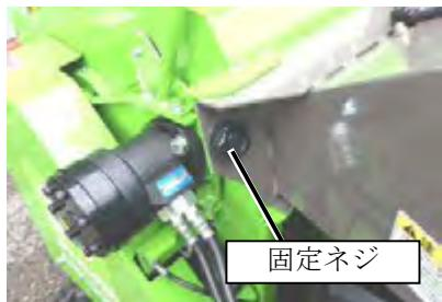
3. 受刃を下側から固定しているM12の受刃固定ボルト（3本）を外して下さい。
