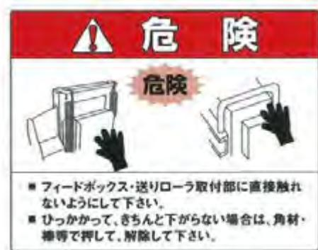
(1) ひっかかりを除去した際に、送りローラ部が所定の位置まで下りますが、その際に手等がはさまれる恐れがあり大変危険ですので、フィードボックス・送りローラ取付部に直接触れないようにして下さい。
