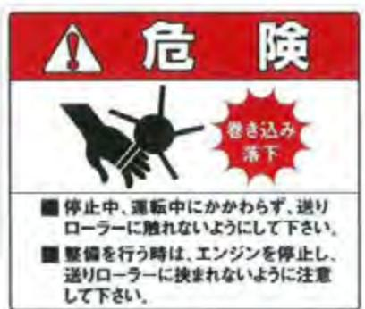
(1) 停止中・運転中にかかわらず、送りローラに触れないようにして下さい。
