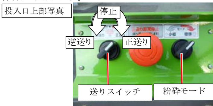
⑦ 作業が終わりましたら、⑥送りスイッチ「停止」→ ④スロットルレバー「低」→ ⑤ロータークラッチレバー「切」の順で、始めの位置に戻し終了してください。
