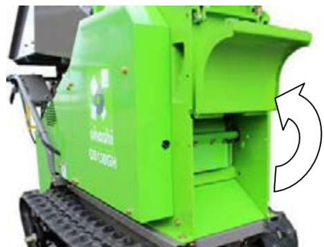
3. 安全ガードを挿入し、取付ネジを締めて下さい。
