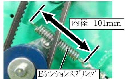
6. パワーパックベルトを取り付け、Pテンションアームスプリングの長さが写真のようになるまで張って下さい。
