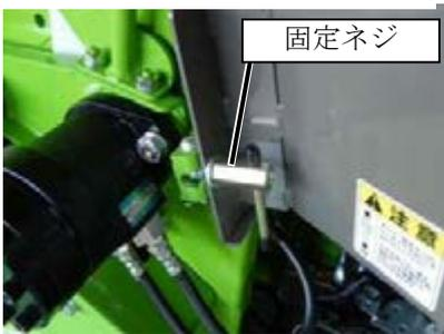
3. 受刃を下側から固定しているM12の受刃固定ボルト（３本）を外して下さい。
