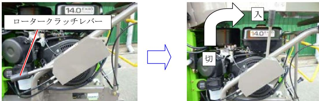
⑥ 投入口上部の粉碎モードを「標準」へ、送りスイッチを「正送り」へすると、粉碎作業が出来ます。
