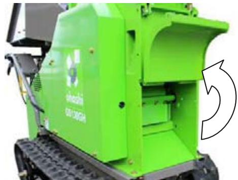
3. 安全ガードを挿入し、取付ネジを締めて下さい。
