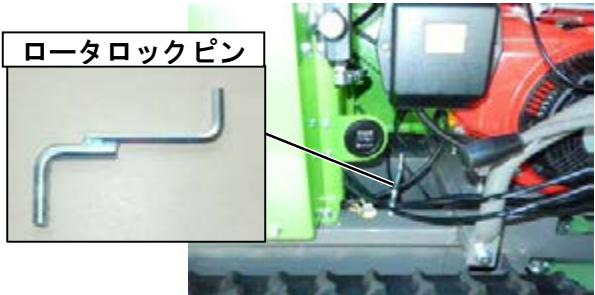
4. ロータを回しロータロックpinが挿せる位置にしてください。ロータロックpinをロータハウジングの左右のどちらかの穴位置に差し、ロータが回らないようにロックしてください。
