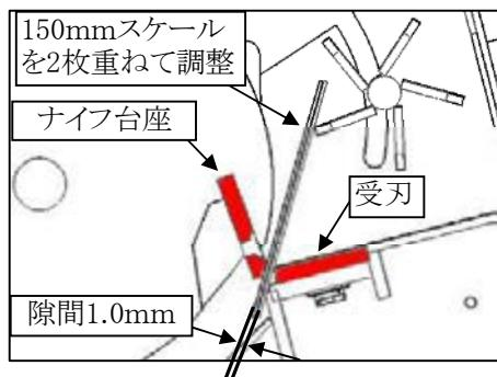
9. 調整後は締め付けトルク 110N·mで受刃の固定ボルト（3本）の締め付けを行って下さい。
