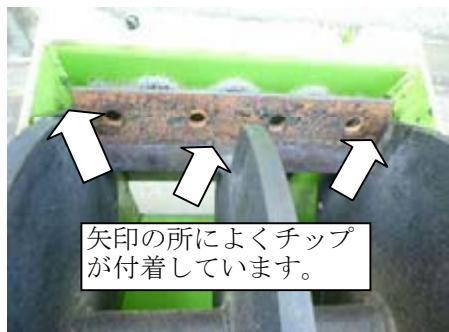
7. チッパナイフを取り外した状態で、ロータのナイフ台座と受刃の隙間調整をして下さい。P 31『受刃の反転・交換・調整』の要領で行ってください。
