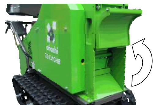
3. 安全ガードを挿入し、取付ネジを締めてください。
