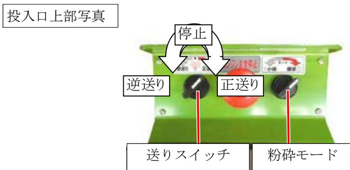
⑦ 作業が終わりましたら、⑥送りスイッチ「停止」→ ④スロットルレバー「低」→ ⑤ロータクラッチレバー「切」 の順で、始めの位置に戻し終了してください。
