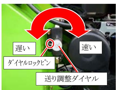
※5mm ・ 8mm スクリーンをつけた場合のダイヤル調整方法は、送り調整ダイヤルを左方向(遅く)へ全部回し、投入口に直径7cm前後の竹や木を投入し、下記の要領で行ってください。
