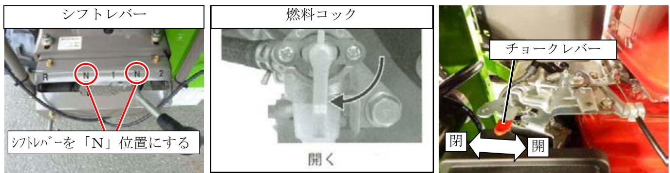
③ エンジンキーを『始動』位置に回しエンジンをかけます。チョークを「開」方向に戻してください。
