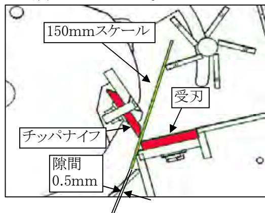
10. 調整後、チッパナイフの六角穴付皿ボルト(各4ヶ)を締付けトルク **110 N·m**で締めてください。
