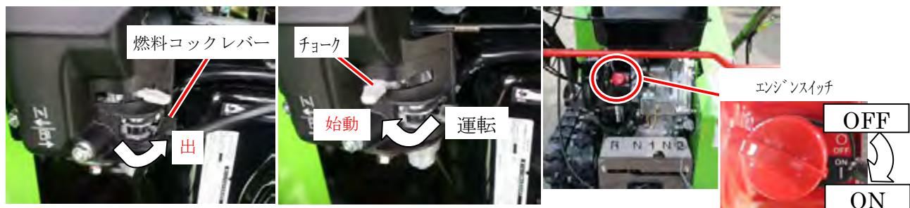
⑤ 始動グリップを静かに引き、重くなるところで止めます。次に矢印方向に強く引っ張りエンジンをかけます。エンジンが始動したらチョークを「運転」の位置にもどします。
