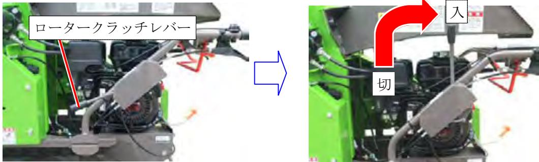
⑦ 投入口上部の送りスイッチを正送りへすると、粉碎作業が出来ます。
