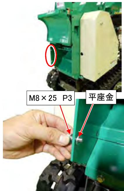
3. 安全ガードを挿入し、2. と反対側はM8×25 P3のボルトを挿し込み仮締めして下さい。
