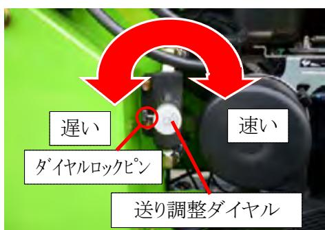
※5mm・8mmスクリーンをつけた場合のダイヤル調整方法は、送り調整ダイヤルを左方向(遅く)へ全部回し、投入口に直径7cm前後の竹や木を投入し、下記の要領で行ってください。
