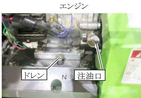
(1) エンジンを水平にし、オイル給油キャップを外し、注入口の口元までオイルがあるか確認してください。
