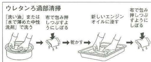
(4) 清掃後、ろ過部をクリーナベースに置きカバーを取り付けてください。
