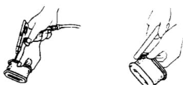
(3) ウレタンろ過部は、「洗い油」または「水で薄めた中性洗剤」で洗浄してください。洗浄後、エンジンオイルに浸し固くしぼってください。
