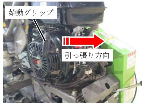
8. エンジン始動後、負荷をかけずに2～3分程低速で暖気運転してください。
