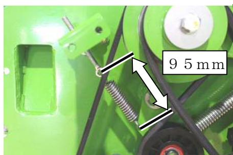
6. パワーパックベルトを取り付け、Pテンションアームスプリングの長さが写真のようになるまで張ってください。
