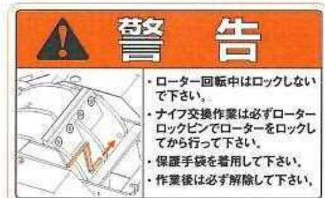
5. チッパナイフに取り付けている六角穴付皿ボルト・ナットを緩め取り外してください。
