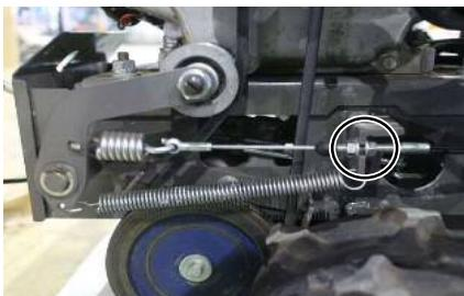
4. 走行クラッチレバーを「下」位置（走行クラッチが切れます）にしてエンジン始動の要領でエンジンを始動し、走行ベルトクラッチが確実に切れることを確認してください。
