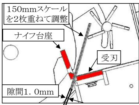
9. 調整後は締め付けトルク 110N·mで受刃の固定ボルト（3本）の締め付けを行ってください。
