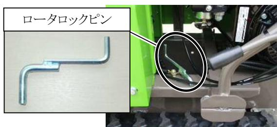
4. ロータを回しロータロックピンが挿せる位置にしてください。ロータロックピンをロータハウジングの左右のどちらかの穴位置に差し、ロータが回らないようにロックしてください。
