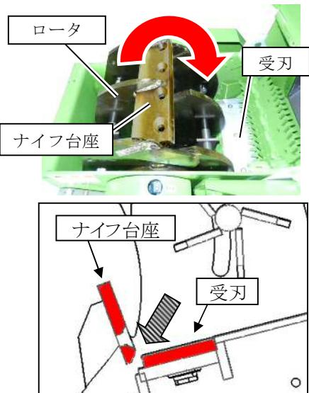
8. 付属のゲージ2枚を重ねて（150mmスケールの厚みで）受刃とナイフ台座の隙間（1.0mm）を調整します。受刃を動かし隙間調整をしてください。
