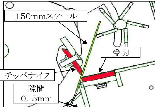
10. 調整後、チッパナイフの六角穴付皿ボルト(各4ヶ)を締付けトルク110N·mで締めてください。
