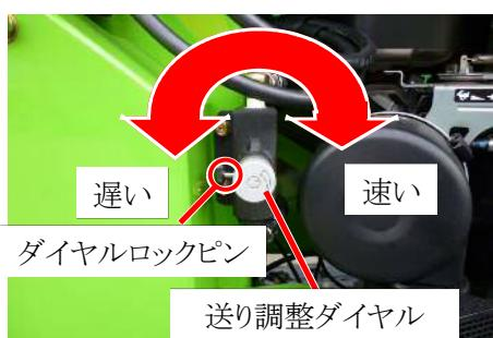
※5mm ・ 8mm スクリーンをつけた場合のダイヤル調整方法は、送り調整ダイヤルを左方向(遅く)へ全部回し、投入口に直径7cm前後の竹や木を投入し、下記の要領で行ってください。
