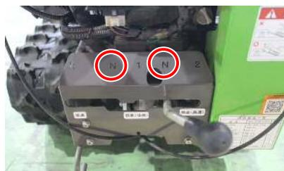
④ 燃料コックレバーを「出」、チョークを「始動」位置にし、エンジンスイッチを「ON」にします。
