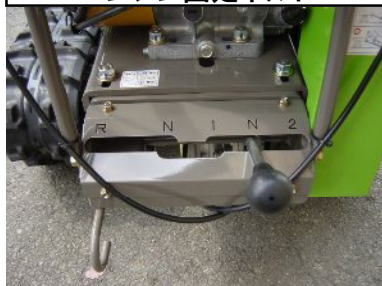
エンジン固定ボルト
