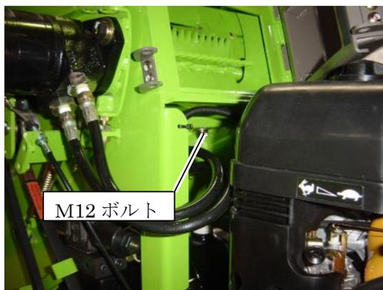
3. 受刃を下側から固定している M12 の受刃固定ボルト（2本）を外して下さい。
