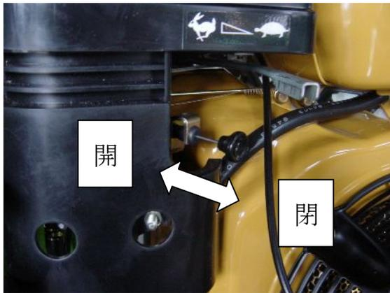
9. 給油の際は、エンジンを停止しリングピンを抜いて、ホッパーを開けて下さい。
