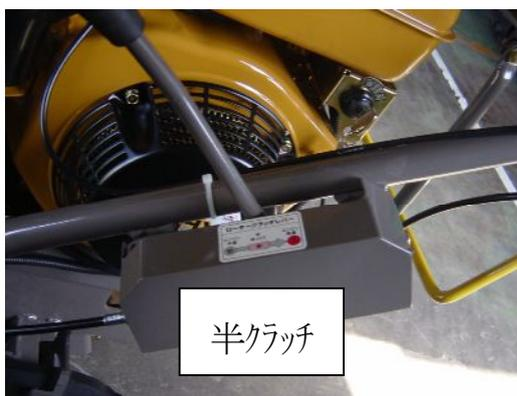
3. ロータ回転が上昇し定速になるまでロータクラッチレバーを保持します。
