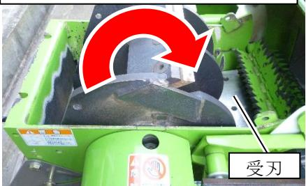
12. チッパナイフの反転、または交換、調整後は、ロータロックピンとロータカバー、投入口のホッパーを元に戻し、固定ネジをしっかりと締め付けてください。
