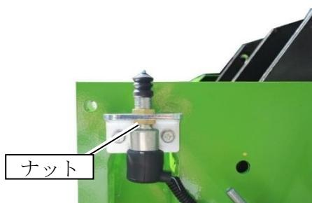
3. ロータカバーを閉めたときにセフティスイッチ先端がみえなくなるように調整してください。
