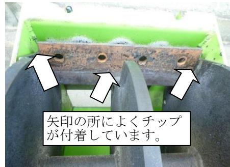
7. チッパナイフを取り外した状態で、ロータのナイフ台座と受刃の隙間調整をしてください。P 3 6 『受刃の反転・交換・調整』の要領で行ってください。
