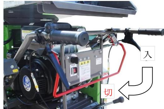
② シフトレバーを「N」の位置にし、燃料コックを「開」方向にして、粉碎装置を『ON』にします。
