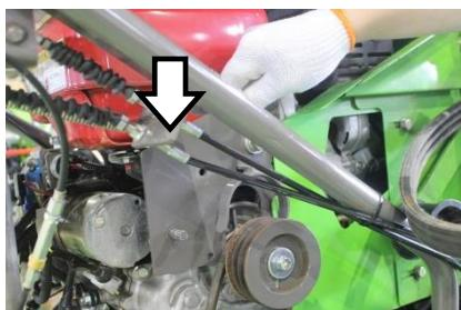
10. 1. 走行クラッチの調整の要領でEベルトササエ1とMベルトササエの位置調整を行い、固定ボルトを締めてください。
