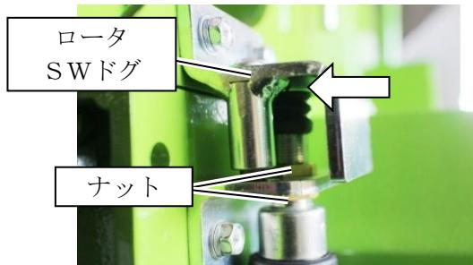
4. 調整後、セフティスイッチのナットを締めてください。
