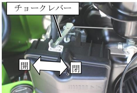
11. エンジン始動後、負荷をかけずに5分程低速で**暖気運転**をしてください。
