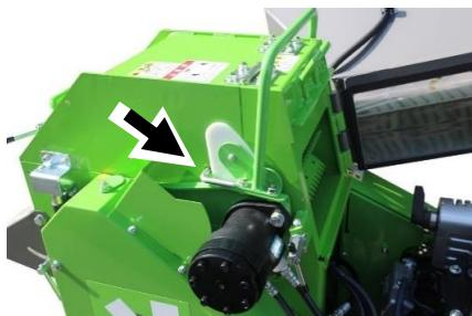
※ 差し込む際は、エンジンを停止しホッパ固定ネジを緩め、ホッパを開けてから行うとスムーズに差し込むことができます。
