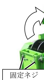
2. ロータに片側のみシュレッダナイフジクオサエを取り付け、SW付ナット（M8）で固定します。
