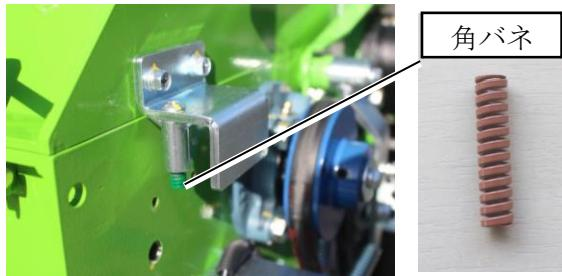
ロータカバーの固定ネジを緩めても隙間（下記写真丸印部分の隙間）ができなくなってきた時、（バネがへたっている時）は角バネの交換を行ってください。
