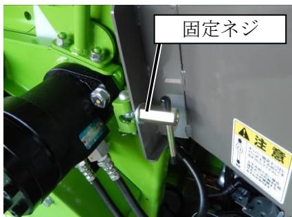
5. 受刃を下側から固定しているM12の受刃固定ボルト（3本）を外してください。
