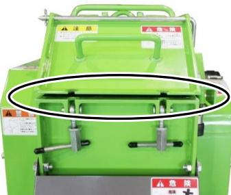
6. ロータカバーが隙間がある時、セフティスイッチの先端が見えるか確認してください。 (下記矢印部分)
