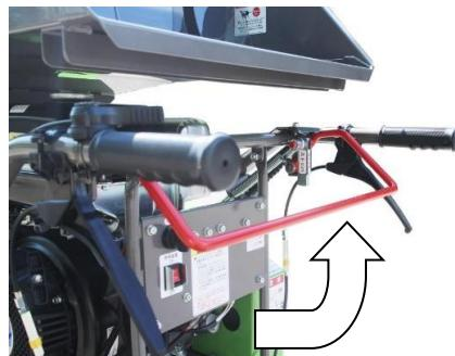
5. スロットルレバーの位置を変えて速度を調整します。
