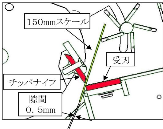
10. 調整後、チッパナイフの六角穴付皿ボルト(各4ヶ)を締付けトルク
