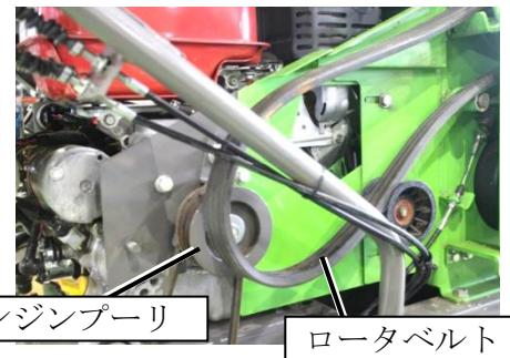
※ ロータベルトが外れない場合は、エンジンを固定しているM 10の固定ナット(4ヶ)を緩めてエンジンの位置を調整してから取り外してください。
