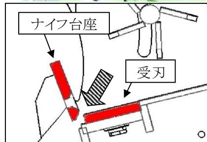
8. 付属のゲージ2枚を重ねて（150mmスケールの厚みで）受刃とナイフ台座の隙間（1.0mm）を調整します。受刃を動かし隙間調整をしてください。
