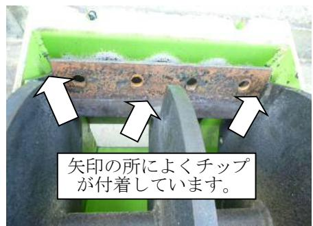
8. チッパナイフを取り外した状態で、ロータのナイフ台座と受刃の隙間調整をしてください。P 3 8 『受刃の反転・交換・調整』の要領で行ってください。
