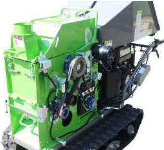
3. ロータカバーを開き、ロータスイッチプラケットを取り外してください。
