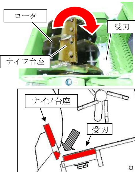
9. 付属のゲージ2枚を重ねて（150mmスケールの厚みで）受刃とナイフ台座の隙間（1.0mm）を調整します。受刃を動かし隙間調整をしてください。
