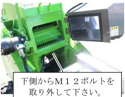
7. 受刃を反転、または交換しM12の受刃固定ボルト（3本）を軽く締めます。（受刃台座が長穴になっております）
