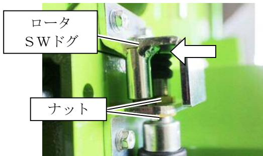
(4) 調整後、セフティスイッチのナットを締めてください。
