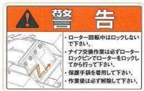
6. チッパナイフに取り付けている六角穴付皿ボルト・ナットを緩め取り外してください。
