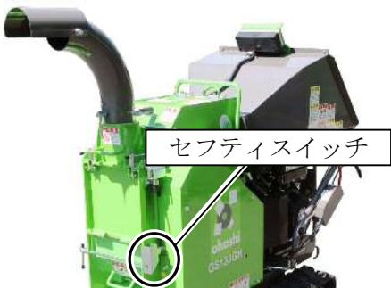
ブロワカバーSWドグ、平座金、固定ハンドルが取り付いている時に、セフティスイッチの先端が見えている場合は、セフティスイッチの位置調整を行ってください。
