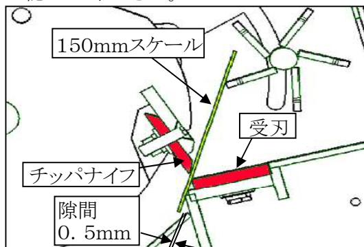
11. 調整後、チッパナイフの六角穴付皿ボルト（各4ヶ）を締付けトルク **110 N·m**で締めてください。
