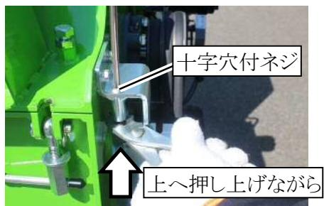
7. ロータカバーを開き、ロータスイッチプラケットを取り付けしてください。
