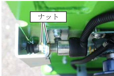
(2) セフティスイッチの先端（下記写真丸印部分）が見えなくなるように調節してください。調節後ナットを締めてください。
