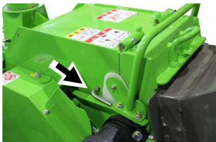
※ 差し込む際は、エンジンを停止しホッパ固定ネジを緩め、ホッパを開けてから行うとスムーズに差し込む事ができます。
