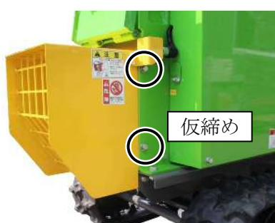
4. 手順3. と反対側の取付穴に六角ボルトと平座金を挿し込み仮締めしてください。
