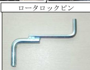
5. ロータを回しロータロックピンが挿せる位置にしてください。ロータロックピンをロータハウジングの左右のどちらかの穴位置に差し、ロータが回らないようにロックしてください。
