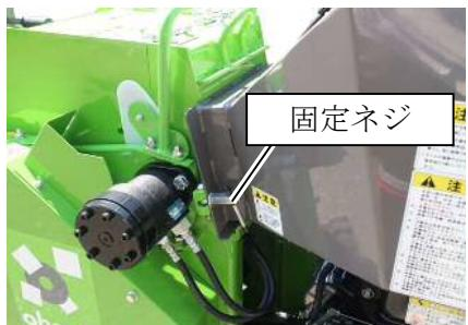
6. 受刃を下側から固定しているM12の受刃固定ボルト（3本）を外してください。
