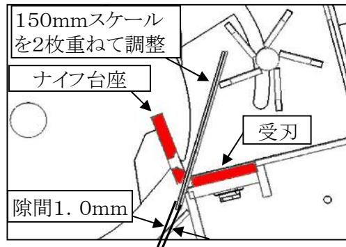
10. 調整後は締め付けトルク 110N·mで受刃の固定ボルト（3本）の締め付けを行ってください。
