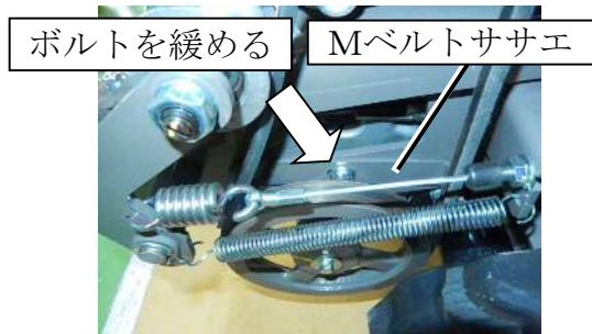
8. 古い走行ベルトを外してください。新しい走行ベルトを取り付けます。
