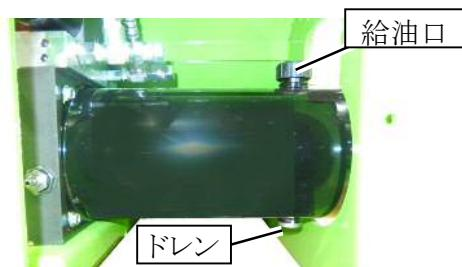
(1) パワーパック裏側のドレンプラグを外して作動油を抜き取ります。
