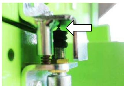
※真横からみて、セフティスイッチの先端(丸印部分)が見えたなら可。
