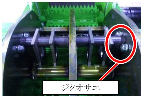
6. ロータを $180^{\circ}$ 回した反対側も、同様にシュレッダーナイフを取り付けます。
