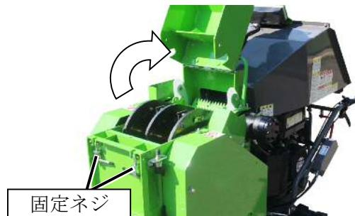
3. ロータに片側のみシュレッダナイフジクオサエを取り付け、M8 SW付ナットで固定します。
