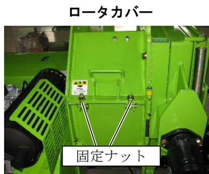
2. ロータクラッチレバーを「切」位置にして、ロータを回しチップナイフが点検窓にくる位置にして下さい。
