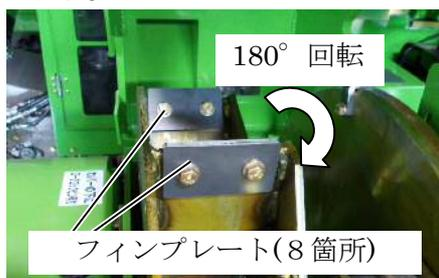
5. M8 のボルトをしっかりと締め付けます。
