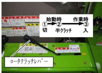
1. ロータクラッチが、確実に切れている事を確認してからエンジンを始動させ、スロットルレバーを「中」位置にして、エンジン回転を上げます。
