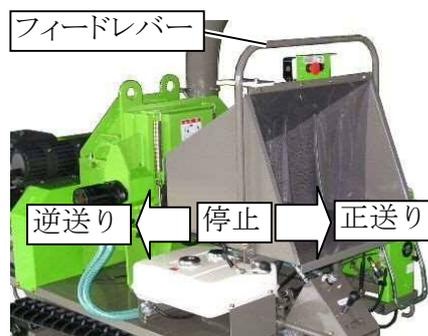
1. フィードレバーを手前に引くと送りローラは正転し材料をロータ内部へ搬送します。
