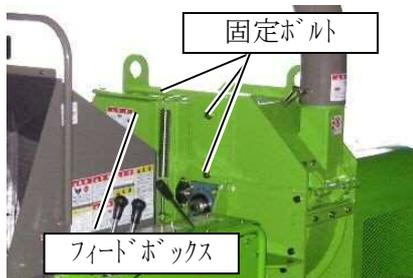
3. 受刃を下側から止めているM12の受刃固定ボルト（2本）を緩めて下さい。
