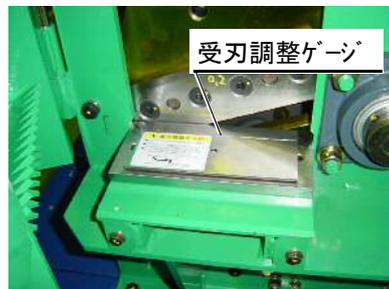
5. 2枚のチップナイフのうち、受刃とのすきまの狭い方を基準にしてアジャストボルトを動かし、ロータを回転させながらチップナイフと受刃のすき間が均等に、なおかつすき間と調整ゲージの板厚が等しくなるように調整して下さい。
