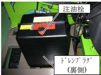
1. 作動油の交換はドレンプラグを外し作動油を全量交換して下さい。
