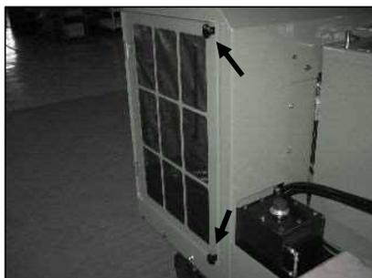
(2) ラジエータネット、ラジエータフィンを清掃します。
