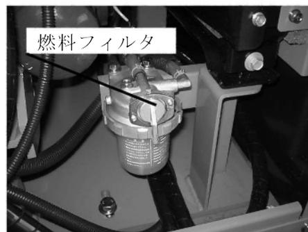
(2) フィルタ交換後、エア抜きをします。
