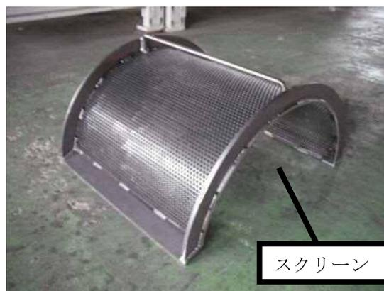
機械の故障を防ぐために、粉碎作業時は必ずスクリーンを装着して作業を行って下さい。
