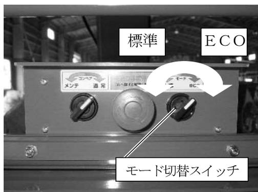
送り制御スイッチの「標準モード」と「ECOモード」位置では過大な負荷(太くて長い材料等を入れた場合)がかかりますと、ロータの回転が下がり、送りは自動的に停止し、ロータの回転が上がると送りは自動的に復帰します。
