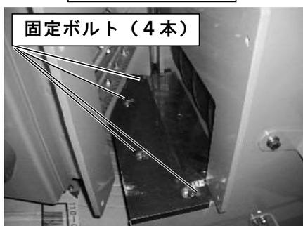
3. 受刃を止めている M12 の受刃固定ボルト（3本）を外し、受刃を反転または交換して下さい。
