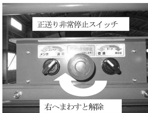
1. 正送り非常停止スイッチを押すと、送りローラの正転のみ停止します。
