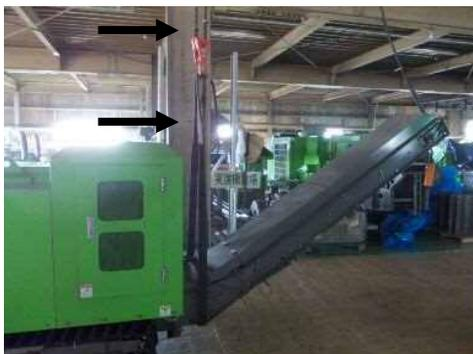
(2)吊り上げたまま、コンベアを抜く向きに引き出してください。この時、コンベアだけでなく UNIC 等も一緒に動かして下さい。
