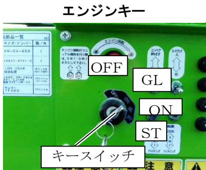
5. キーを差し込み、右に回しGL位置にし、約3～5秒間保持します。更に右へ回しST位置に入れエンジンが始動したらすぐ離します。（キーはON位置に止まります。）キーをGL位置に10秒以上入れて置かないで下さい。
