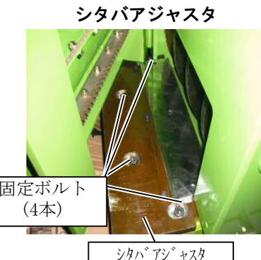
3. 受刃を止めているM12の受刃固定ボルト（4本）を外し、受刃を反転または交換して下さい。
