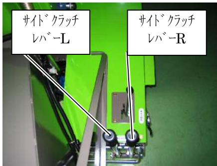
1. 左折する場合は、サイドクラッチレバーLを手前に引きます。左側のクーラーが停止し、機体は左折します。
