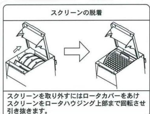
1. ロータカバーの固定ネジを緩めロータカバーを開けて下さい。
