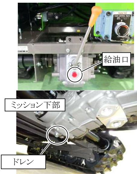
タンクカバーを取り外してから給油をして下さい。
