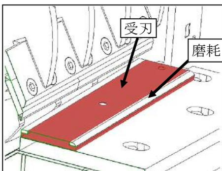
4. 受刃の反転または交換したシタバアジャスタを取り付けます。必ず**P40の『ナイフの調整』**の要領でチップナイフと受刃のすき間を調整して下さい。
