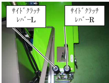
1. 左折する場合は、サイドクラッチレバーLを手前に引きます。左側のクローラが停止し、機体は左折します。
