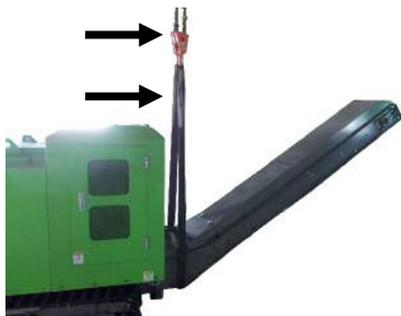
(2) 吊り上げたまま、コンベアを抜く向きに引き出してください。この時、コンベアだけでなくUNIC等も一緒に動かして下さい。
