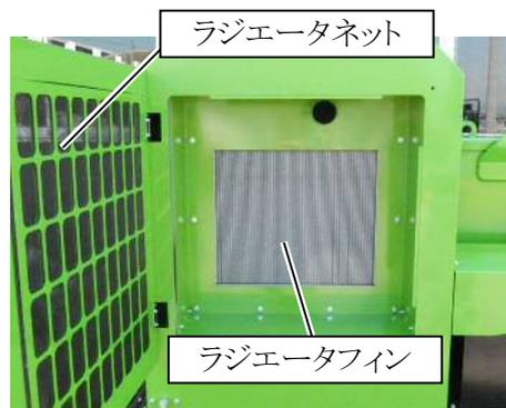
(3) カバーを閉じます。ノブボルトを締め固定します。
