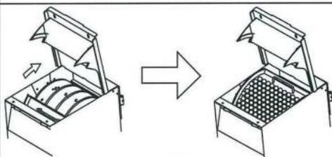
スクリーンを取り外すにはロータカバーをあけスクリーンをロータハウジング上部まで回転させ引き抜きます。
