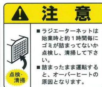
ラジエータネットにゴミが入った場合、及びラジエータフィン表面にゴミが付着した場合は、取外して圧縮空気できれいに清掃して下さい。
