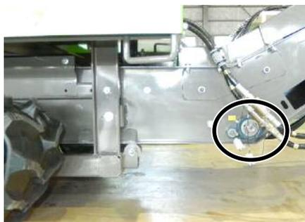
(1) 上図のベアリング下方に、吊り上げ用ヒモをかけ、UNIC等で軽く吊り上げて下さい。
