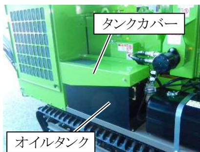
1. 作動油の交換はドレンプラグを外して全量交換して下さい。ドレンプラグは排油後、古いシールテープを取ってきれいに洗浄し新しいシールテープを巻いて締めて下さい。
