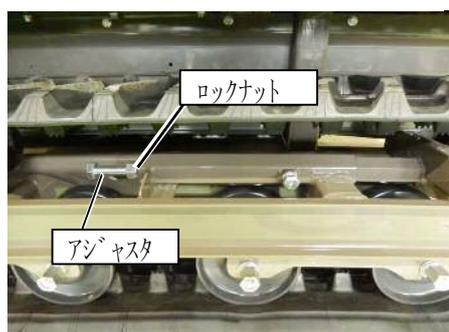
4. クローラ張りボルトを回して、クローラと転輪の隙間（図中A）が10～15mm程度（転輪が水平な状態で）になるよう調整します。
