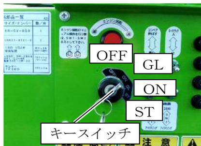
5. キーを差し込み、右に回しGL位置にし、約3～5秒間保持します。更に右へ回しST位置に入れエンジンが始動したらすぐ離します。(キーはON位置に止まります。) キーをGL位置に10秒以上入れて置かないで下さい。
