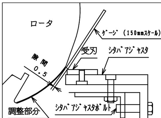
6. 手でロータをゆっくり回して、2枚のチップナイフと受刃が当たらないことと、隙間が0.5mm前後あることを確認して下さい。
