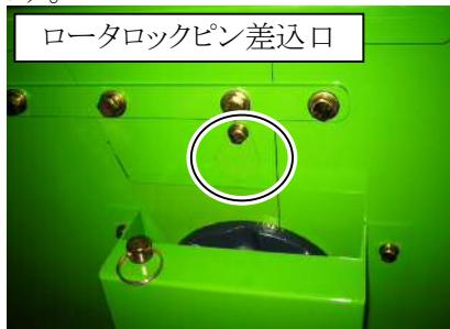
3. 六角レンチにてM14の六角穴付皿ボルト(8本)を固定し、裏側にあるM14の固定ナットを外し、チッパナイフを反転または交換してください。
