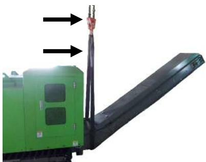
(2) 吊り上げたまま、コンベアを抜く向きに引き出してください。この時、コンベアだけでなくUNIC等も一緒に動かしてください。
