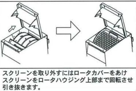
1. ロータカバーの固定ネジを緩めロータカバーを開けてください。
