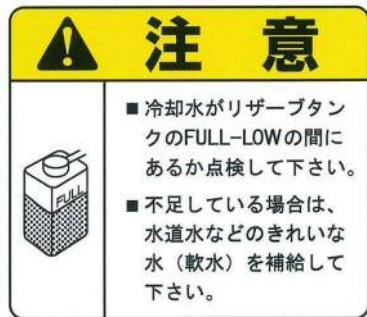
運転前には、冷却水量の点検を習慣付けてください。（冷却水容量は、5.8Lです。）
