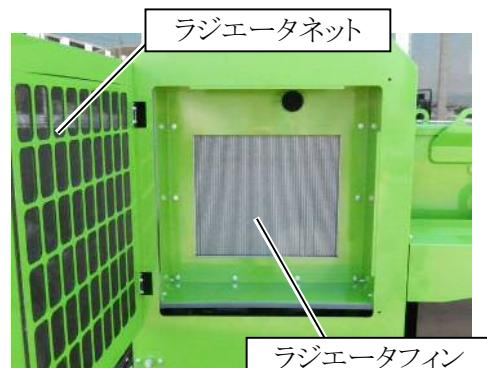
(3) カバーを閉じます。ノブボルトを締め固定します。
