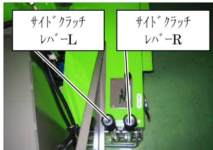
1. 左折する場合は、サイドクラッチレバーLを手前に引きます。左側のクーラが停止し、機体は左折します。
