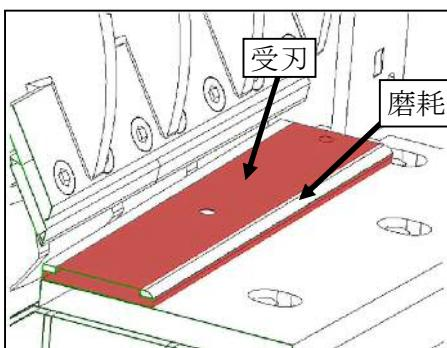
4. 受刃の反転または交換したシタバアジャスターを取り付けます。必ず『ナイフの調整』(P41) の要領でチッパナイフと受刃のすき間を調整してください。
