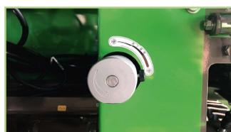
「送り速度調整ダイヤル」で破碎材を送る速度を調整することができます。チップサイズは2～16mm程度まで調整可能です。
