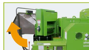
エンジン搭載部やローター一部などは開閉可能で日常点検やナイフ交換などメンテナンスがし易い構造に設計されています。
