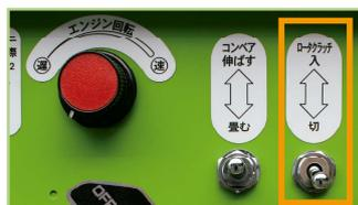
ロータークラッチの操作はスイッチ式で、接続作業を操作パネルで容易に行えます。
