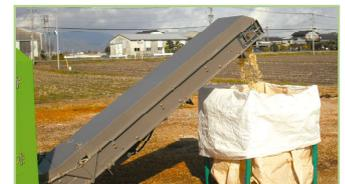
コンベア排出タイプでフレコンバッグや2トン車荷台等へのチップの回収も楽に行えます。
