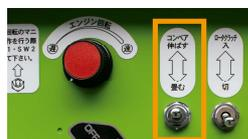
排出コンベアは油圧式により簡単に折りたたむことができます。作業現場での移動やトラックへの積み込み・積み降ろしが容易に行えます。飛散防止カバー付き。
