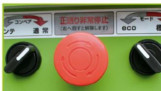
異物混入時には、投入口上部の非常停止ボタンで正送りを停止させ、巻き込み事故を防止します。
