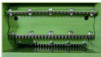
破碎材を送り込むフィードローラーの「送りツメ」は経済的なボルト式で、磨耗した際には簡単に部品交換が可能です。
