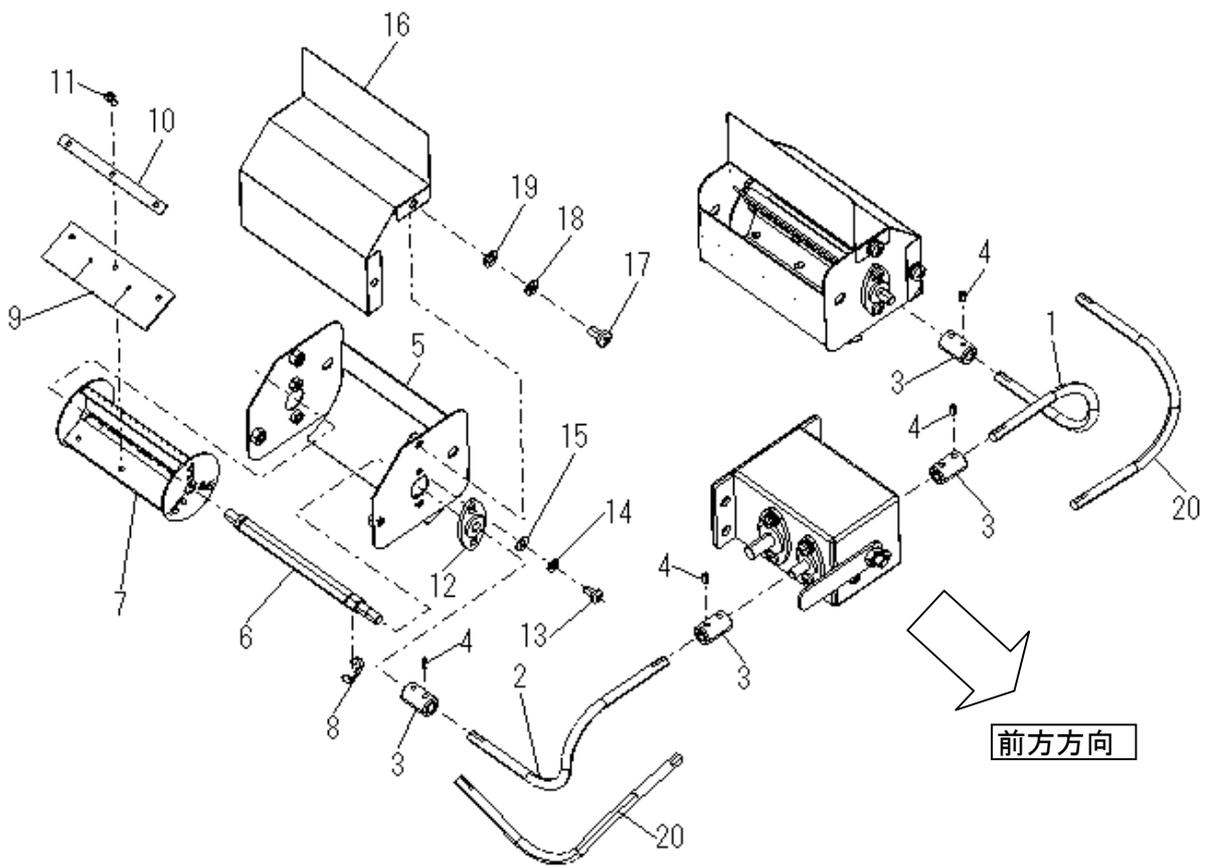
Fig. 6 飛散ロータ
