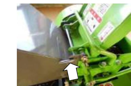
3. 六角レンチにて固定ボルト（3本）を固定し、裏側にあるナットを緩め固定ボルト（3本）を外してください。
