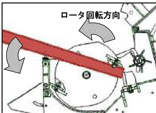
7. 送りローラ解除レバーを解除方向に引いて、噛み込みの解除を行い、粉碎物を取り除きます。
