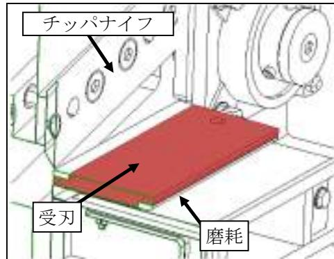
4. **受刃の調整(P30)**の要領で受刃の調整を行い、受刃固定ボルト（2本）をしっかりと締め付けます。
