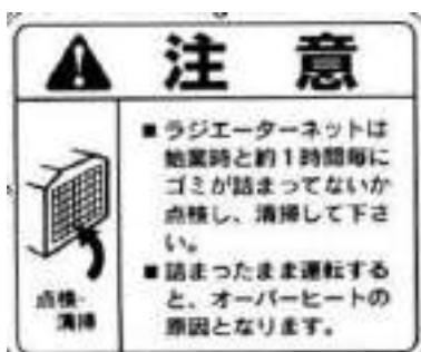
ラジエータネットにゴミが入った場合、及びラジエータフィン表面にゴミが付着した場合は、取外して圧縮空気できれいに清掃して下さい。
