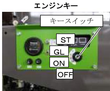
6. エンジン始動後、負荷をかけずに5分間、低速で暖気運転します。（エンジン取扱説明書参照）
