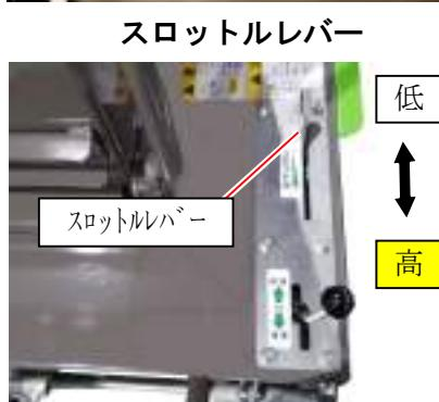
3. スロットルレバーが『低』位置になっていることを確認し、ロータクラッチスイッチを「入」へ倒します。
