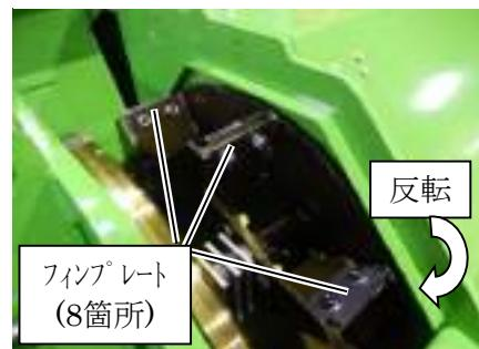
5. M10のボルトをしっかりと締め付けます。
