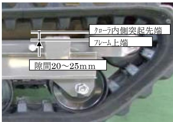
3. 調整後は、ロックボルトとアジャストナットを確実に締め付けてアイドラーを固定して下さい。
