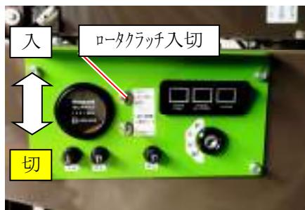
2. ロータクラッチスイッチを「切」へ倒します。
