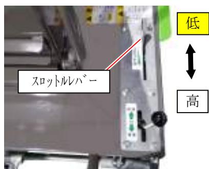
1. 粉碎作業終了後スロットルレバーをゆっくり『低』へ倒し、ロータの回転を十分に落として下さい。
