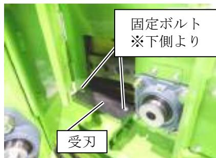
4. 受刃調整ゲージの直角曲げ部分を受刃の先端にセットします。
