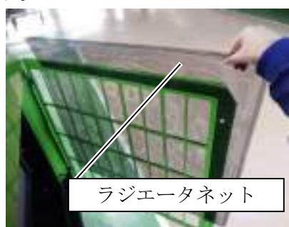
(3) ラジエータネットを元に戻し、M8のノブボルト（2本）を締め付けます。
