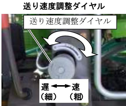
送り速度は送り速度調整ダイヤルで調整出来ます。作業条件に合わせて送り速度を調整して下さい。
