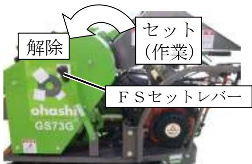
6. 粉碎物が噛み込んでいる場合（③の場合）は以下の手順でロータを回し、噛み込みを解除させてください。
