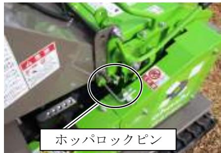
10. 抜いたホッパロックピンを挿して、ホッパを固定してください。
