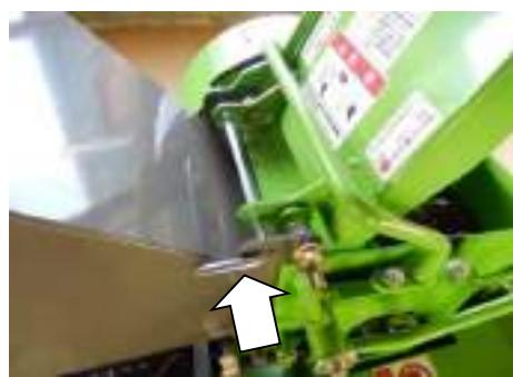
3. 六角レンチにて固定ボルト（3本）を固定し、裏側にあるナットを緩め固定ボルト（3本）を外してください。
