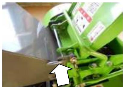
(3) 棒状のものをロータに差し込み、ロータを回転させて下さい。
