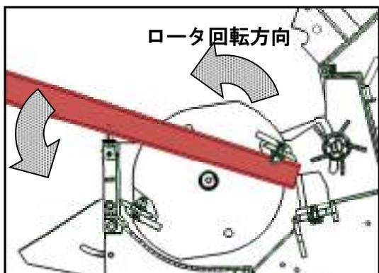
7. 送りローラ解除レバーを解除方向に引いて、噛み込みの解除を行い、粉碎物を取り除きます。
