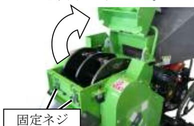
2. 投入口方向から見て左側面土台のフレームよりロータロックピンを抜き取ります。
