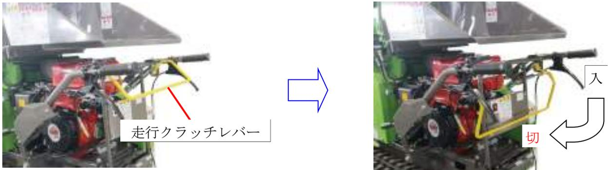
② シフトレバーを「N」の位置にし、燃料コックを「開」方向にして、粉碎装置を『ON』にします。
