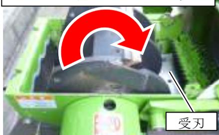
12. チップナイフの反転、または交換、調整後は、ロータロックピンとロータカバー、投入口のホップを元に戻し、固定ネジをしっかりと締め付けてください。
