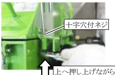
6. ロータカバーを開き、ロータスイッチブラケットを取り付けしてください。
