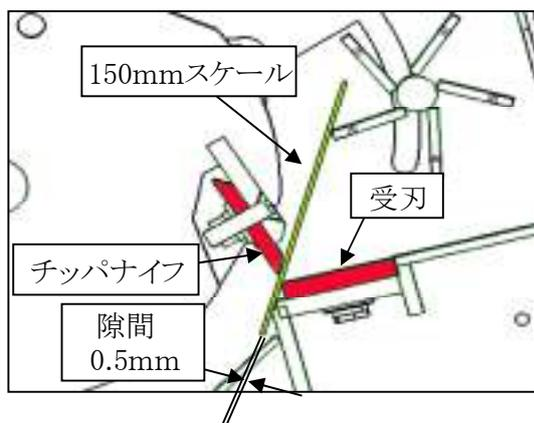
10. 調整後、チップナイフの六角穴付皿ボルト(各4ヶ)を締付けトルク **110 N・m**で締めて下さい。
