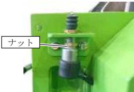
(3) ロータカバーを閉めたときにセフティスイッチ先端がみえなくなるように調整してください。
