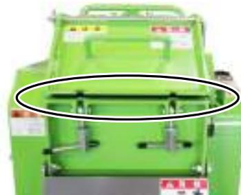
(6) ロータカバーが隙間がある時、セフティスイッチの先端が見えるか確認してください。(下記矢印部分)
