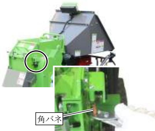
ロータカバーの固定ネジを緩めても隙間（下記写真丸印部分の隙間）ができなくなってきた時、（バネがへたっている時は角バネの交換を行ってください。
