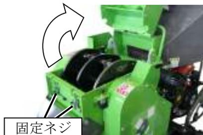
2. ロータに片側のみシュレッダーナイフジクオサエを取り付け、M8 SW付ナットで固定します。
