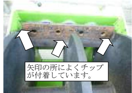
7. チップナイフを取り外した状態で、ロータのナイフ台座と受刃の隙間調整をしてください。P35『受刃の反転・交換・調整』の要領で行ってください。
