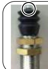
※真横からみて、セフティスイッチの先端(丸印部分)が見えたたら可。
