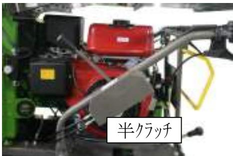
3. ロータ回転が上昇し定速になるまでロータクラッチレバーを保持します。
