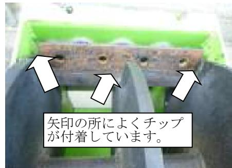
7. チッパナイフを取り外した状態で、ロータのナイフ台座と受刃の隙間調整をしてください。P 35『受刃の反転・交換・調整』の要領で行ってください。
