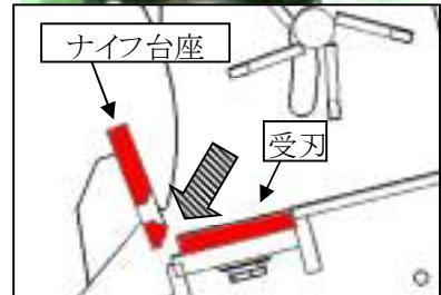
8. 付属のゲージ2枚を重ねて（150mmスケールの厚みで）受刃とナイフ台座の隙間（1.0mm）を調整します。受刃を動かし隙間調整をしてください。
