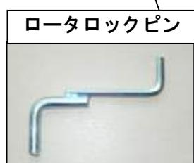
4. ロータを回しロータロックpinが挿せる位置にしてください。ロータロックpinをロータハウジングの左右のどちらかの穴位置に差し、ロータが回らないようにロックしてください。
