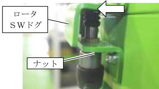
(4) 調節後、セフティスイッチのナットを締めてください。
