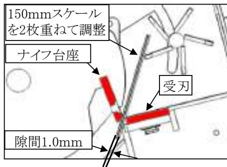
10. 調整後は締め付けトルク 110N·mで受刃の固定ボルト（3本）の締め付けを行ってください。
