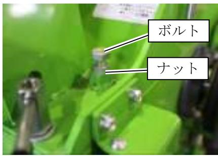
1. ロータカバーを閉めて、固定ネジを閉めてください。
