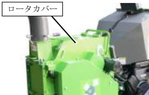
6. ブロワカバーが閉まっている事、ブロワカバーSWドグを取り付けしている事を確認してください。
