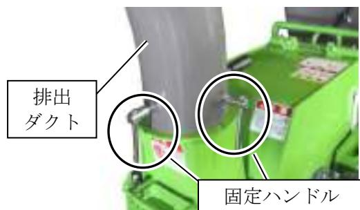
2. ロータカバーの固定ネジを緩め、ロータカバーを開けてください。
