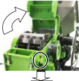
ロータカバーの固定ネジを緩めても隙間（下記写真丸印部分の隙間）ができなくなってきた時、（バネがへたっている時）は角バネの交換を行ってください。
