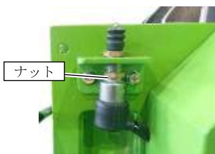
(3) ロータカバーを閉めたときにセフティスイッチ先端がみえなくなるように調整してください。
