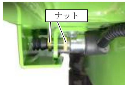
プロワカバーSWドグ、平座金、ナイロンナットが取り付いている時に、セフティスイッチの先端が見えている場合は、セフティスイッチの位置調整を行ってください。
