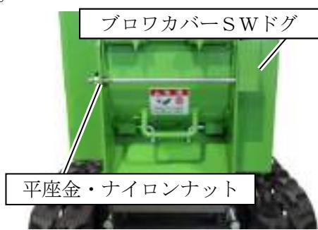
(2) セフティスイッチの先端（下記写真丸印部分）が見えなくなるよう調節してください。調節後ナットを締めてください。
