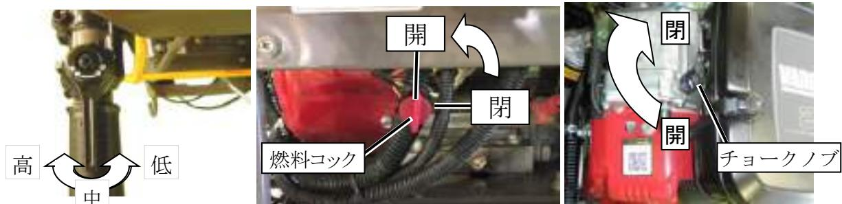
④ キースイッチを「ON」方向に回しエンジンをかけます。チョークノブを「開」方向に徐々に戻してください。
