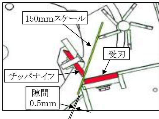
11. 調整後、チッパナイフの六角穴付皿ボルト(各4ヶ)を締付けトルク
