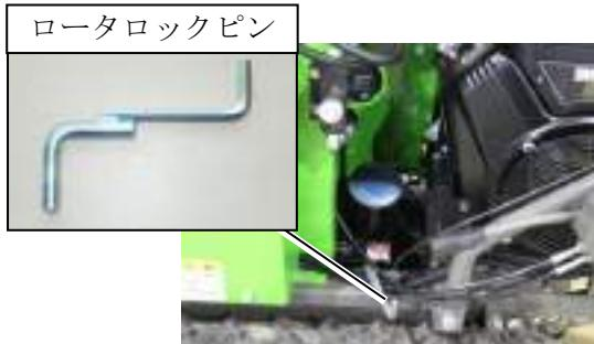
5. ロータを回しロータロックpinが挿せる位置にしてください。ロータロックpinをロータハウジングの左右のどちらかの穴位置に差し、ロータが回らないようにロックしてください。
