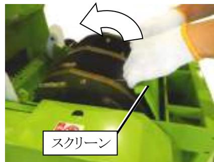
5. スクリーンの交換が終わったら、ロータカバーを閉めて、ロータカバーの固定ネジをしっかりと締めてください。
