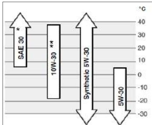
※ 外気温4°C以下でSAE30のオイルを使用すると始動不良となります。
