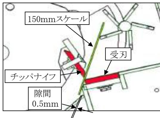
11. 調整後、チッパナイフの六角穴皿ボルト(各4ヶ)を締付けトルク110N・mで締めてください。
