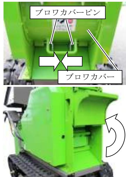
4. 安全ガードを挿入し、取付ネジを締めてください。
