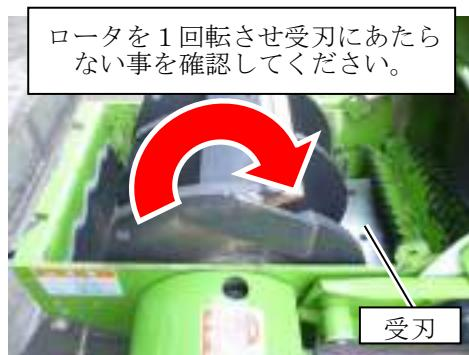
13. チッパナイフの反転、または交換、調整後は、ロータロックピンとロータカバー、投入口のホッパを元に戻し、固定ネジをしっかりと締め付けてください。
