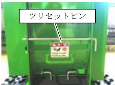
3. プロワカバーにあるプロワカバーピンを引き出して開けてください。
