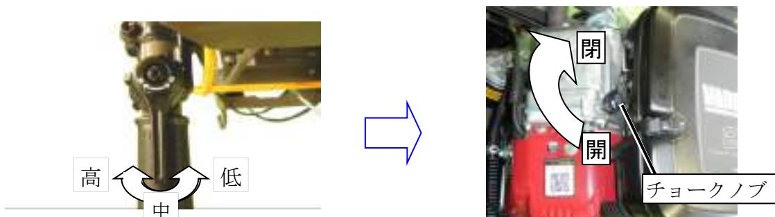
④ キースイッチを「ON」方向に回しエンジンをかけます。チョークノブを「開」方向に徐々に戻してください。
