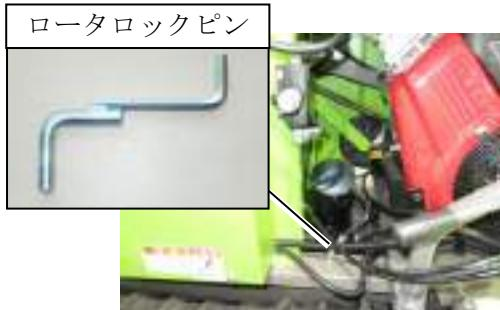
5. ロータを回しロータロックpinが挿せる位置にしてください。ロータロックpinをロータハウジングの左右のどちらかの穴位置に差し、ロータが回らないようにロックしてください。
