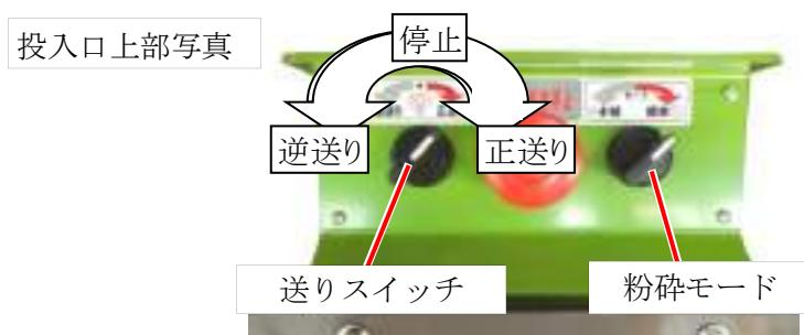
⑧ 作業が終わりましたら、⑦送りスイッチ・停止→⑤スロットルレバー・低位置→⑥ロータクラッチレバー「切」の順で、始めの位置に戻し終了してください。
