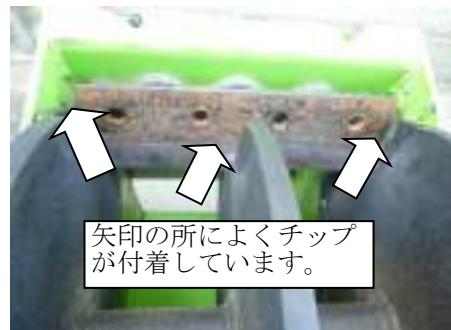
8. チッパナイフを取り外した状態で、ロータのナイフ台座と受刃の隙間調整をしてください。P29『受刃の反転・交換・調整』の要領で行ってください。
