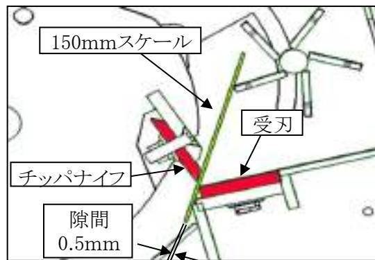
11. 調整後、チッパナイフの六角穴付皿ボルト(各4ヶ)を締付けトルク110N・mで締めてください。
