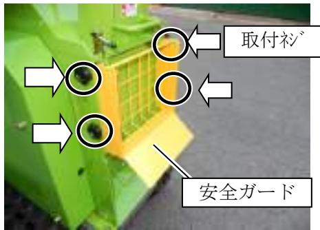
2. プロワカバーにあるプロアカバーピンを引き出して開けてください。
