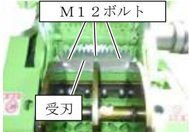
7. 受刃を反転、または交換しM12の受刃固定ボルト（3本）を軽く締めます。（受刃台座が長穴になっております）
