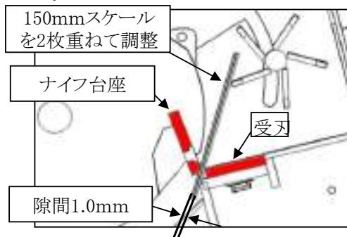
10. 調整後は締め付けトルク 110N·mで受刃の固定ボルト（3本）の締め付けを行ってください。
