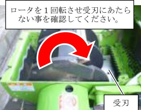
13. チッパナイフの反転、または交換、調整後は、ロータロックピンとロータカバー、投入口のホッパを元に戻し、固定ネジをしっかりと締め付けてください。
