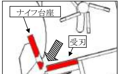
9. 付属のゲージ2枚を重ねて（150mmスケールの厚みで）受刃とナイフ台座の隙間（1.0mm）を調整します。受刃を動かし隙間調整をしてください。
