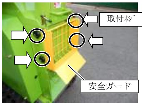
2. プロワカバーにあるプロアカバーピンを引き出して開けてください。
