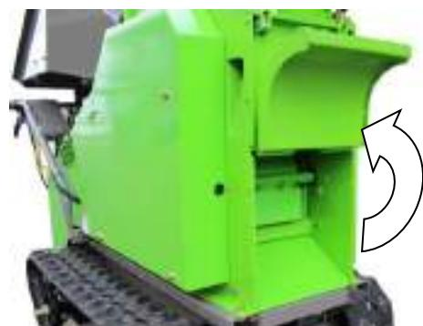
3. 安全ガードを挿入し、取付ネジを締めてください。
