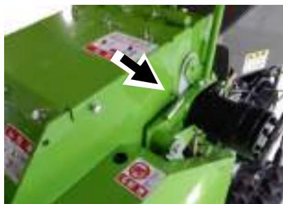
(3) 吊作業が終わったら、ツリセットピンは元の位置に戻して下さい。
