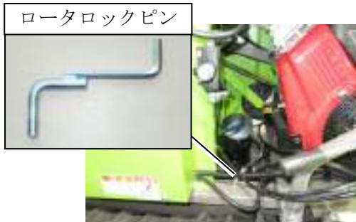
5. ロータを回しロータロックpinが挿せる位置にしてください。ロータロックpinをロータハウジングの左右のどちらかの穴位置に差し、ロータが回らないようにロックしてください。
