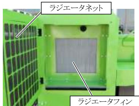
(3) カバーを閉じます。ノブボルトを締め固定します。
