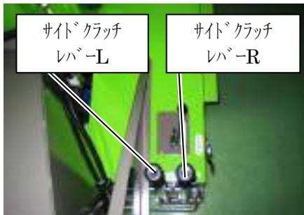
1. 左折する場合は、サイドクラッチレバーLを手前に引きます。左側のクロークが停止し、機体は左折します。
