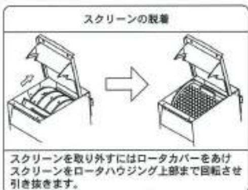
1. ロータカバーの固定ネジを緩めロータカバーを開けてください。
