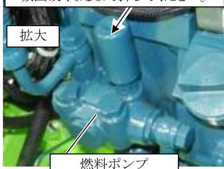
(1) エンジンオイル給油口横にある燃料ポンプの部分を押すことでエア抜きができます。初めは軽いですが、数回押すごとに硬くなっています。硬くなるまで様子をみながら押してください。
