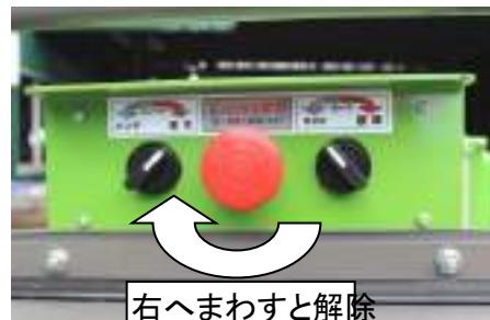
1. 正送り非常停止スイッチを押すと、送りローラの正転のみ停止します。
