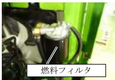
(1) 定期点検表（エンジン取扱説明書参照）にしたがって、燃料フィルタカートリッジの交換を行ってください。
