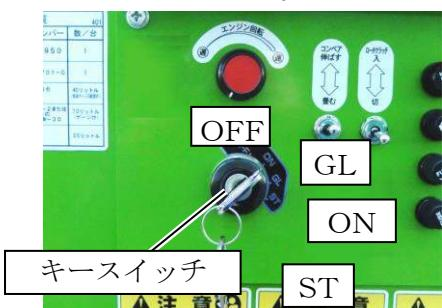
5. キーを差し込み、右に回し G L 位置にし、約 3~5 秒間保持します。更に右へ回し S T 位置に入れエンジンが始動したらすぐ離します。
