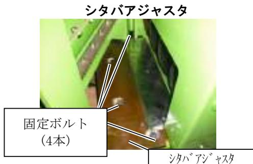
3. 受刃を止めているM12の受刃固定ボルト(4本)を外し、受刃を反転または交換してください。
