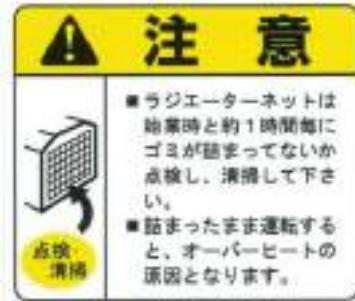
ラジエータネットにゴミが入った場合、及びラジエータフィン表面にゴミが付着した場合は、取外して圧縮空気できれいに清掃してください。
