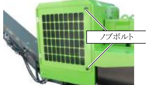
(2) ラジエータネット、ラジエータフィンを清掃します。
