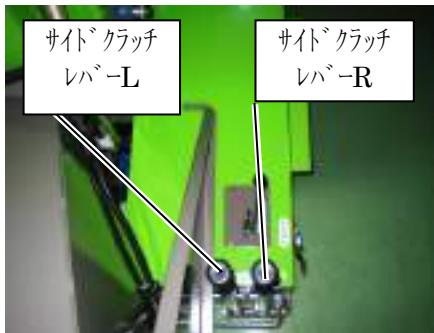
1. 左折する場合は、サイドクラッチレバーLを手前に引きます。左側のクロークが停止し、機体は左折します。
