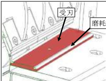
4. 受刃の反転または交換したシタバアジャスタを取り付けます。必ず『ナイフの調整』の要領でチッパナイフと受刃のすき間を調整してください。
