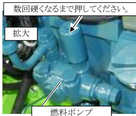
(1) エンジンオイル給油口横にある燃料ポンプの部分を押すことでエア抜きができます。初めは軽いですが、数回押すごとに硬くなっています。硬くなるまで様子をみながら押してください。
