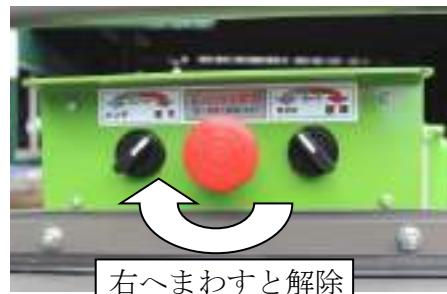
1. 正送り非常停止スイッチを押すと、送りローラの正転のみ停止します。
