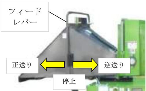
1. フィードレバーを手前に引くと送りローラは正転し材料をロータ内部へ搬送します。
