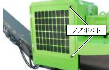
(2) ラジエータネット、ラジエータフィンを清掃します。
