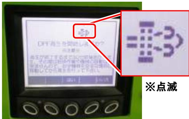
(2) この画面が表示された場合、作業を中断し、フィードレバーを「停止」位置にし、ロータクラッチスイッチを「切」位置にし安全な場所まで機械を移動させてください。
