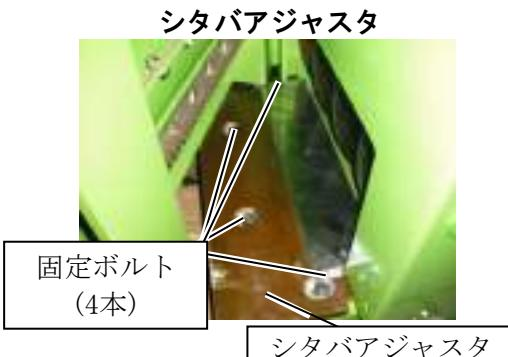
3. 受刃を止めているM12の受刃固定ボルト(4本)を外し、受刃を反転または交換してください。
