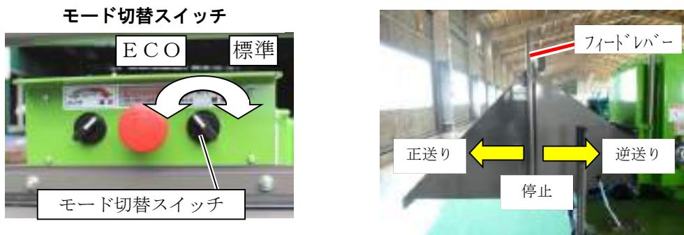
⑦ 作業が終わりましたら、フィードレバーを「停止」位置にし、スロットルダイヤルをゆっくり「遅」位置までおとし、**ベルトの回転が確実にさがった事を確認してから**、ロータクラッチスイッチを「切」位置にし、20秒程度してからエンジンを停止させてください。
