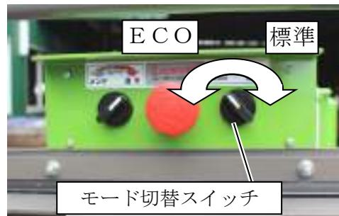
送り制御スイッチの「標準モード」と「ECOモード」位置では過大な負荷（太くて長い材料等を入れた場合）がかかりますと、ロータの回転が下がり、送りは自動的に停止し、ロータの回転が上がると送りは自動的に復帰します。
