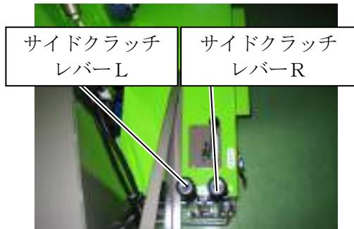
1. 左折する場合は、サイドクラッチレバーLを手前に引きます。左側のクーラが停止し、機体は左折します。
