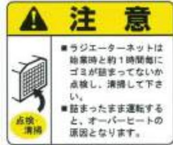
ラジエータネットにゴミが入った場合、及びラジエータフィン表面にゴミが付着した場合は、取外して圧縮空気で清掃してください。
