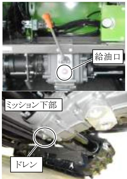
タンクカバーを取り外してから給油をして下さい。
