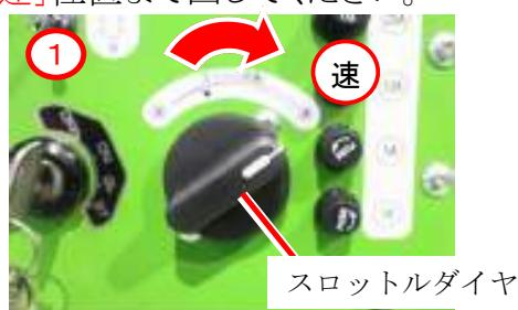
⑥ モード切替スイッチを標準にして、フィードレバーを正送りに倒せば粉碎作業が出来ます。
