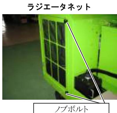
(2) ラジエータネット、ラジエータフィンを清掃します。
