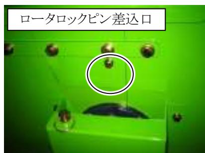
3. 六角レンチにてM14の六角穴付皿ボルト(8本)を固定し、裏側にあるM14の固定ナットを外し、チッパナイフを反転または交換して下さい。
