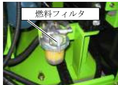
(2) フィルタ交換後、エア抜きをします。
