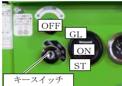
5. キーを差し込み、右に回しGL位置にし、約3～5秒間保持します。更に右へ回しST位置に入れエンジンが始動したらすぐ離します。（キーはON位置に止まります。）キーをGL位置に10秒以上入れて置かないで下さい。始動しない場合は、30秒程間をあけて、もう一度STに回します。
