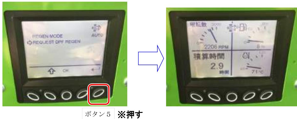
※再生中は以下のマークが点滅から点灯に変ります。消灯したのを確認してから粉碎作業や移動を行って下さい。
