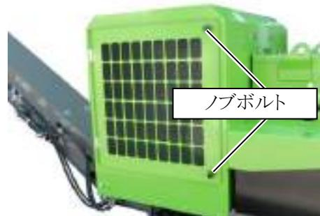
(2) ラジエータネット、ラジエータフィンを清掃します。
