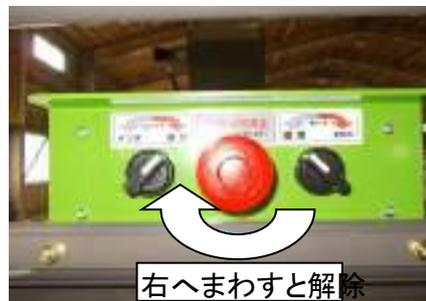
1. 正送り非常停止スイッチを押すと、送りローラの正転のみ停止します。
