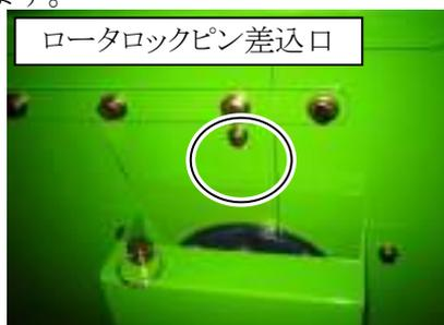
3. 六角レンチにてM14の六角穴付皿ボルト(8本)を固定し、裏側にあるM14の固定ナットを外し、チップナイフを反転または交換して下さい。
