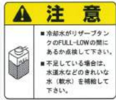
運転前には、冷却水量の点検を習慣付けて下さい。（冷却水容量は、5.8Lです。）
