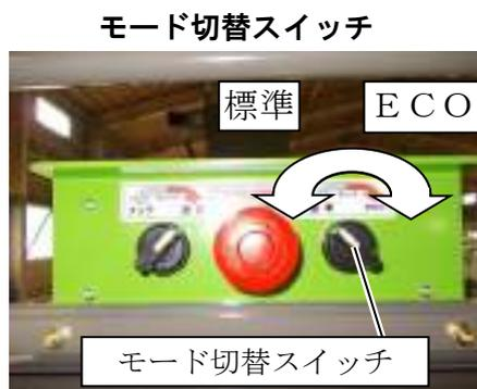
送り制御スイッチの「標準モード」と「ECOモード」位置では過大な負荷（太くて長い材料等を入れた場合）がかかりますと、ロータの回転が下がり、送りは自動的に停止し、ロータの回転が上がると送りは自動的に復帰します。
