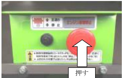
2. エンジン非常停止スイッチは、右へ回すと解除します。（スイッチが元の位置に飛び出します。）
