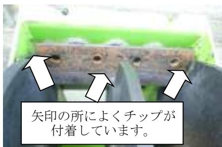
7. チッパナイフを取り外した状態で、ロータのナイフ台座と受刃の隙間調整をしてください。P 26 『受刃の反転・交換・調整』の要領で行ってください。
