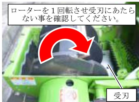
12. チッパナイフの反転、または交換、調整後は、ロータロックピンとロータカバー、投入口のホッパを元に戻し、固定ネジをしっかりと締め付けてください。
