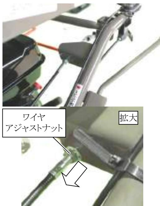
4. 走行クラッチレバーを「下」位置（走行クラッチが切れます）にしてエンジン始動の要領でエンジンを始動し、走行ベルトクラッチが確実に切れることを確認してください。
