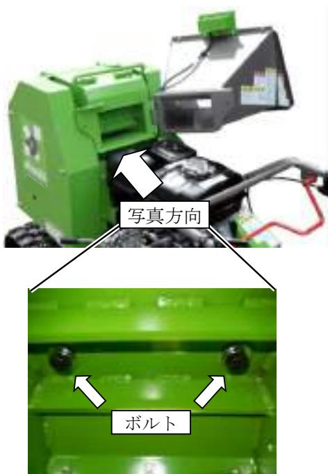
6. 受刃を反転、または交換しM12の受刃固定ボルト（2本）を軽く締めます。（受刃台座が長穴になっております）
