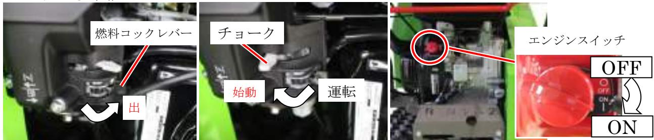
⑤ 始動グリップを静かに引き、重くなるところで止めます。次に矢印方向に強く引っ張りエンジンをかけます。エンジンが始動したらチョークを「運転」の位置にもどします。
