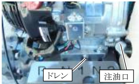
(1) エンジンを水平にし、オイル給油キャップを外し、注入口の口元までオイルがあるか確認してください。
