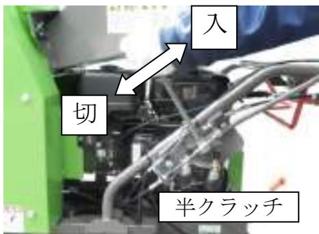
3. ロータ回転が上昇し定速になるまでロータクラッチレバーを保持します。
