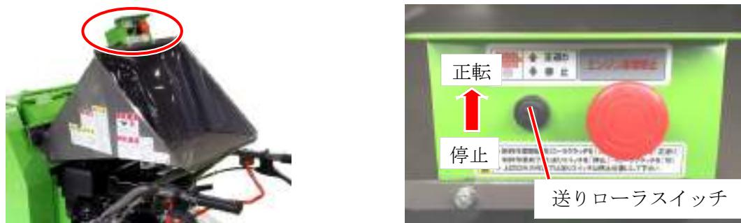
⑨ 作業が終わりましたら、⑧送りスイッチ「停止」→⑥スロットルレバー「低」→⑦ロータクラッチレバー「切」の順で、元の位置に戻し終了してください。
