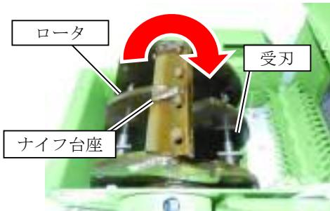
8. 付属のゲージ2枚を重ねて（150mmスケールの厚みで）受刃とナイフ台座の隙間（1.0mm）を調整します。受刃を動かし隙間調整をしてください。
