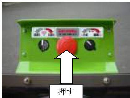
2. エンジン非常停止スイッチは、右へ回すと解除します。（スイッチが元の位置に飛び出します。）
