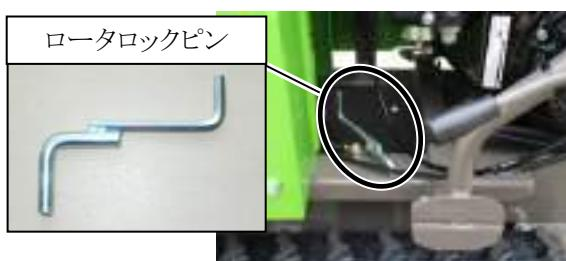
4. ロータを回しロータロックピンが挿せる位置にしてください。ロータロックピンをロータハウジングの左右のどちらかの穴位置に差し、ロータが回らないようにロックしてください。
