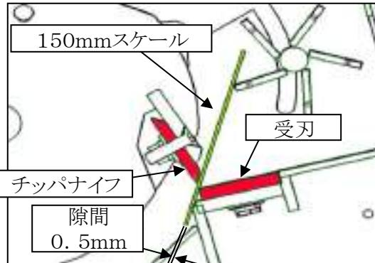
10. 調整後、チッパナイフの六角穴付皿ボルト(各4ヶ)を締付けトルク
