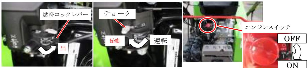
⑤ 始動グリップを静かに引き、重くなるところで止めます。次に矢印方向に強く引っ張りエンジンをかけます。エンジンが始動したらチョークを「運転」の位置にもどします。
