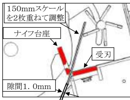
9. 調整後は締め付けトルク 110N·mで受刃の固定ボルト（3本）の締め付けを行ってください。
