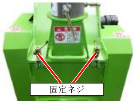
2. ロータに片側のみシュレッダナイフジクオサエを取り付け、M8のSW付ナットで固定します。
