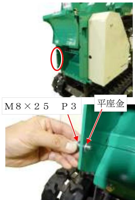
3. 安全ガードを挿入し、2. と反対側はM 8×25 P 3のボルトを挿し込み仮締めしてください。
