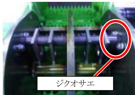
5. ロータを $180^{\circ}$ 回した反対側も、同様にシュレッダナイフを取り付けます。
