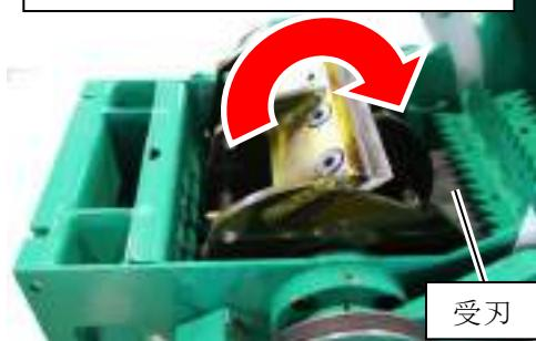
12. チッパナイフの反転、または交換、調整後は、ロータロックピンとロータカバー、投入口のホッパを元に戻し、固定ネジをしっかりと締め付けてください。
