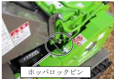
10. 抜いたホッパロックpinを挿して、ホッパを固定してください。
