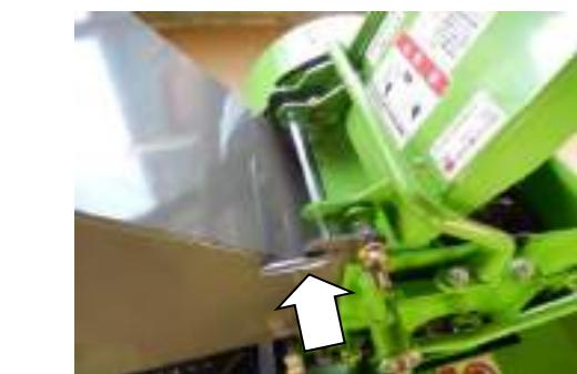
3. 六角レンチにて固定ボルト（3本）を固定し、裏側にあるナットを緩め固定ボルト（3本）を外してください。
