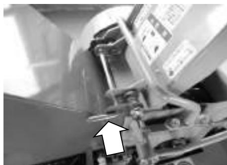
3. シュレッダナイフ軸のナイフ軸固定ボルトを外します。
