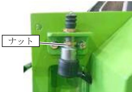
(3) ロータカバーを開めたときにセフティスイッチ先端がみえなくなるように調整してください。
