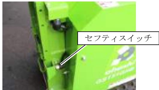
ブロワカバーSWドグ、平座金、ナイロンナットが取り付いている時に、セフティスイッチの先端が見えている場合は、セフティスイッチの位置調整を行ってください。
