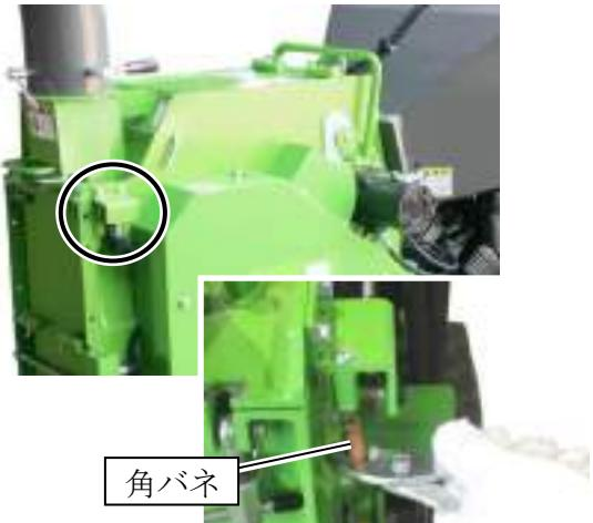
ロータカバーの固定ネジを緩めても隙間
