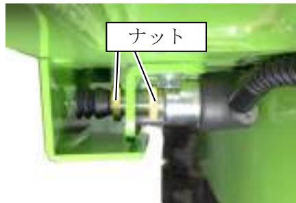
(2) セフティスイッチの先端（下記写真丸印部分）が見えなくなるよう調節してください。調節後ナットを締めてください。
