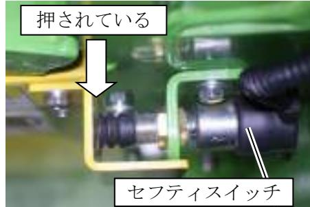
7. セフティスイッチが押されていない場合は、ナットを緩めてセフティスイッチの位置を調節してください。調節後はナットを締めてください。
