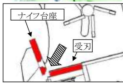
9. 付属のゲージ2枚を重ねて（150mmスケールの厚みで）受刃とナイフ台座の隙間(1.0mm)を調整します。受刃を動かし隙間調整をしてください。
