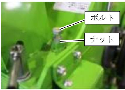
3. ボルトの先がスクリーンにあたるまで、ボルトを締めてください。反対側も同様に調整をしてください。
