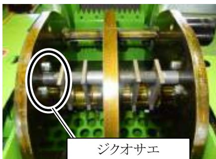
6. ロータを $180^{\circ}$ 回した反対側も、同様にシュレッダナイフを取り付けます。
