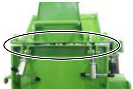
(6) ロータカバーが隙間がある時、セフティスイッチの先端が見えるか確認してください。 (下記矢印部分)
