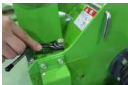
1. ロータカバーを閉めて、固定ネジを閉めてください。
