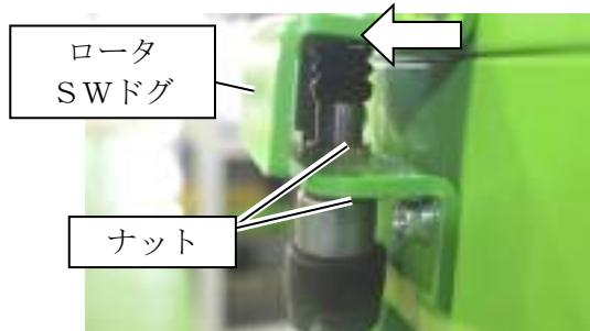
(4) 調節後、セフティスイッチのナットを締めてください。
