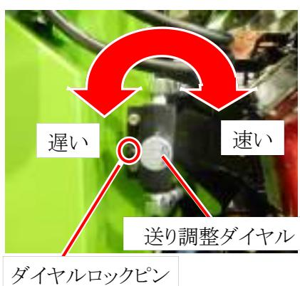
※5mm・8mmスクリーンをつけた場合のダイヤル調整方法は、送り調整ダイヤルを左方向(遅く)へ全部回し、投入口に直径7cm前後の竹や木を投入し、下記の要領で行ってください。
