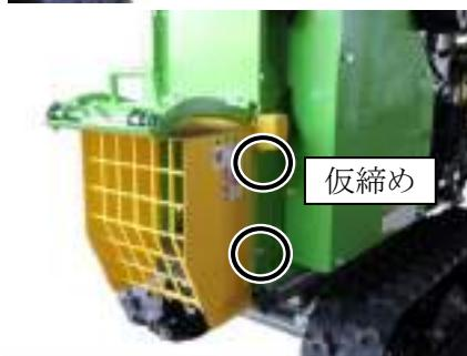
4. 手順3. と反対側の取付穴に六角ボルトと平座金を挿し込み仮締めしてください。
