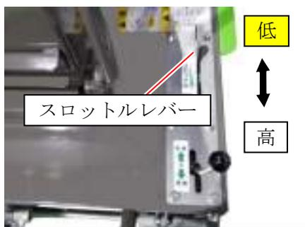
1. 粉碎作業終了後スロットルレバーをゆっくり『低』へ倒し、ロータの回転を十分に落としてください。
