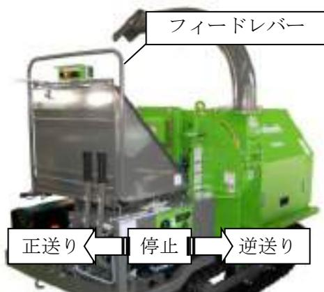
1. フィードレバーを手前に引くと送りローラは正転し材料をロータ内部へ搬送します。
