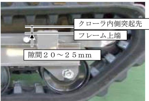
3. 調整後は、ロックボルトとアジャストナットを確実に締め付けてアイドラを固定してください。
