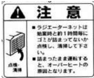
ラジエータネットにゴミが入った場合、及びラジエータフィン表面にゴミが付着した場合は、取外して圧縮空気できれいに清掃してください。また、始業時と運転約1時間毎にラジエータネット、ラジエータフィンにゴミが詰まっていないか点検し、詰まっている場合は清掃してください。
