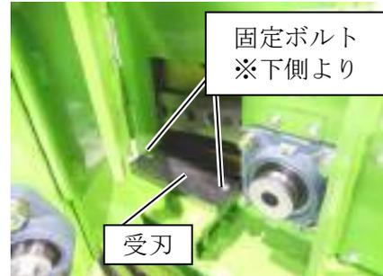
4. 受刃調整ゲージの直角曲げ部分を受刃の先端にセットします。
