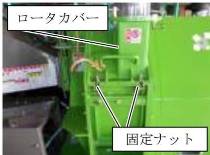
2. フィードボックスを固定している固定ボルト (3本) とホップ左の固定ボルト (1本) を外し、フィードボックスを左へ開けます。
