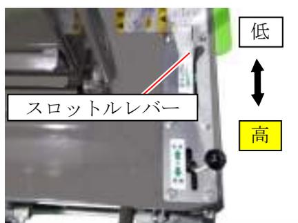
4. ロータクラッチがつながったら、スロットルレバーをゆっくり『高』へ倒し、フルスロットルにします。
