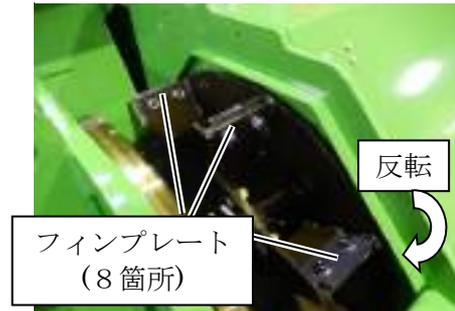
5. M10のボルトをしっかりと締め付けます。
