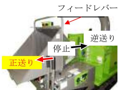
5. フィードレバーを「正送り」、送り制御スイッチを「標準モード」位置し、粉砕作業を開始します。
