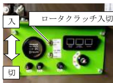
1. ロータクラッチが、確実に切れている事を確認してからエンジンを始動させ、スロットルレバーを「低」位置にします。
