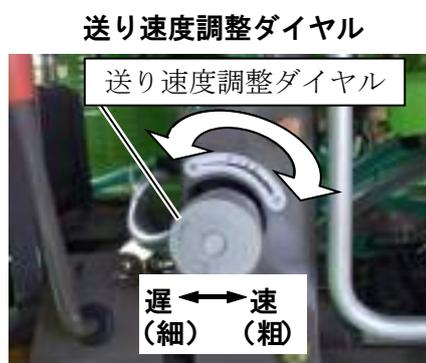
送り速度は送り速度調整ダイヤルで調整出来ます。作業条件に合わせて送り速度を調整してください。
