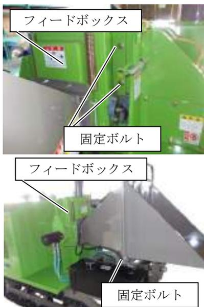
2. 受刃を下側から固定している受刃固定ボルト (2本) を外します。
