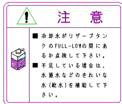
冷却水がリザーブタンクのFULL-LOWの間にあるか点検してください。冷却水が不足している場合は水道水などの、きれいな水（軟水）を補給してください。※クーラント濃度は、30～60%です。
