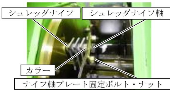
5. シュレッダナイフ軸をネジ込んでSプレートにナイフ軸プレートを接触させ穴(2ヶ)を合わせ、固定ボルト・ナットを差し、しっかりと締め付けます。
