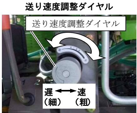
送り速度は送り速度調整ダイヤルで調整出来ます。作業条件に合わせて送り速度を調整してください。
