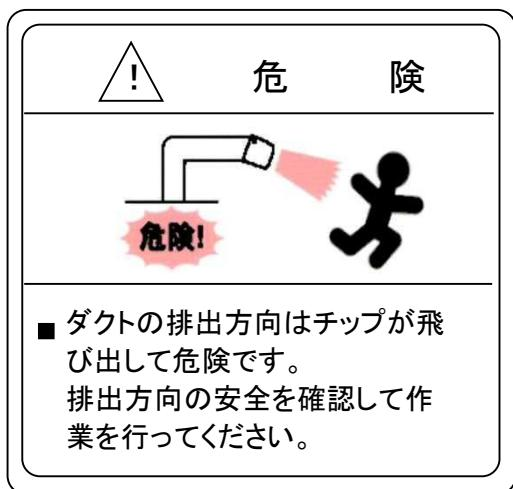
1. 粉碎された材料は、排出ダクトより勢いよく排出されますので事故につながる可能性があります。作業に入る前に、排出ダクトの排出方向を定め、作業中に排出ダクトが動かないようにダクト固定ハンドルをしっかりと締めてから作業を開始してください。
