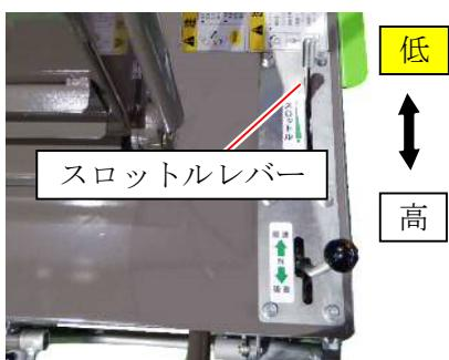
1. 粉碎作業終了後スロットルレバーをゆっくり『低』へ倒し、ロータの回転を十分に落としてください。
