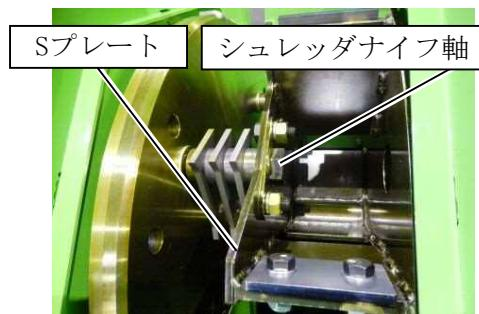
6. ロータカバーを元に戻し固定ナットをしっかりと締め付けます。
