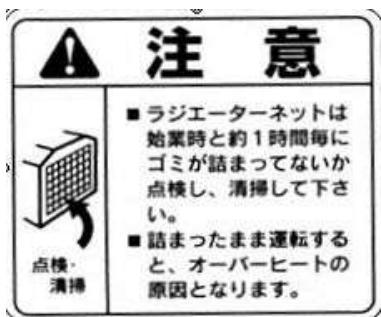
ラジエータネットにゴミが入った場合、及びラジエータフィン表面にゴミが付着した場合は、取外して圧縮空気できれいに清掃してください。
