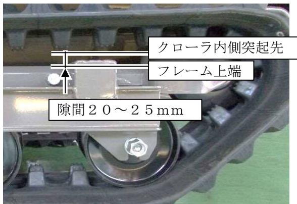
3. 調整後は、ロックボルトとアジャストナットを確実に締め付けてアイドラーを固定してください。
