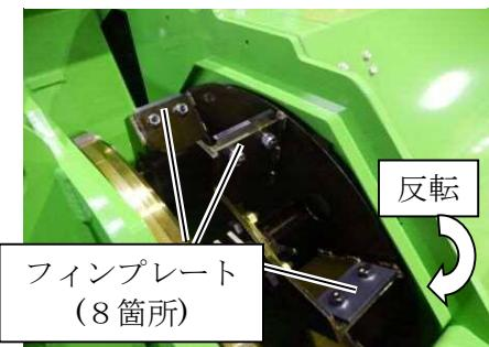
5. M10のボルトをしっかりと締め付けます。
