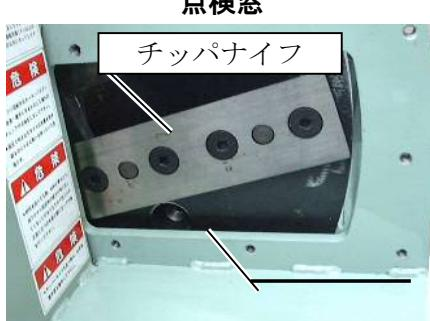
3. ロータロックピンを「ロック」位置に差し、ロータが回らないようにします。
