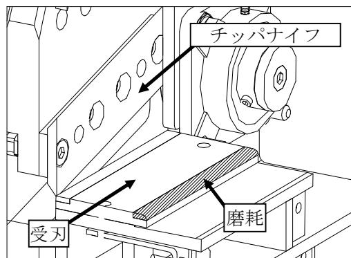
4. **受刃の調整(P30)**の要領で受刃の調整を行い、受刃固定ボルト（2本）をしっかりと締め付けます。
