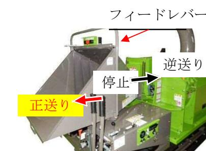
5. フィードレバーを「正送り」、送り制御スイッチを「標準モード」位置し、粉碎作業を開始します。
