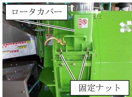
2. フィードボックスを固定している固定ボルト（3本）とホッパ左の固定ボルト（1本）を外し、フィードボックスを左へ開けます。
