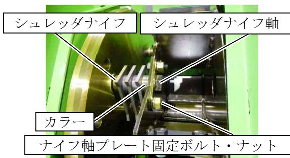
5. シュレッダナイフ軸をネジ込んでSプレートにナイフ軸プレートを接触させ穴（2ヶ）を合わせ、固定ボルト・ナットを差し、しっかりと締め付けます。
