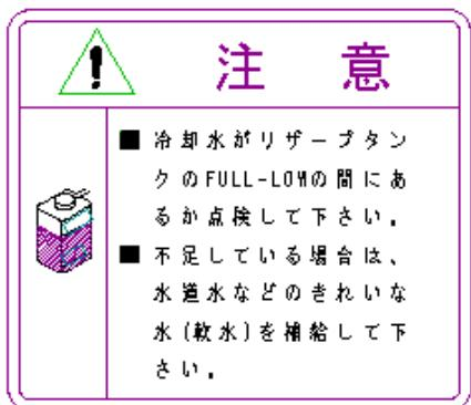
冷却水がリザーブタンクのFULL-LLOWの間にあるか点検してください。冷却水が不足している場合は水道水などの、きれいな水(軟水)を補給してください。
