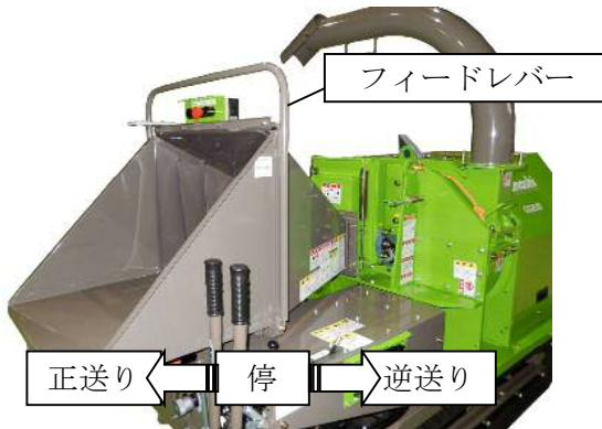
1. フィードレバーを手前に引くと送りローラは正転し材料をロータ内部へ搬送します。
