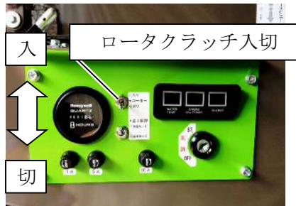
1. ロータクラッチが、確実に切れている事を確認してからエンジンを始動させ、スロットルレバーを「低」位置にします。
