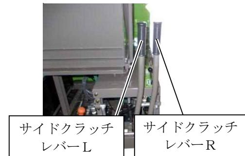
1. 左折する場合は、左側のサイドクラッチレバーを手前に引きます。左側のクローラが停止し、機体は左折します。
